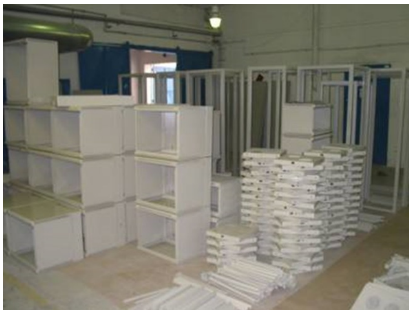
Obrázek 7 Rozvaděčové skříně (interní materiály firmy)
