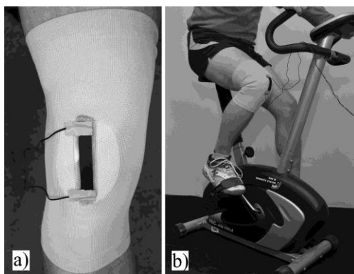
Obr. 4 a) umístění TPU/MWCNT senzorského kompozitu na elastickou kolenní bandáž, b) simulace dynamického namáhání senzoru při šlapání na rotopedu [24].
