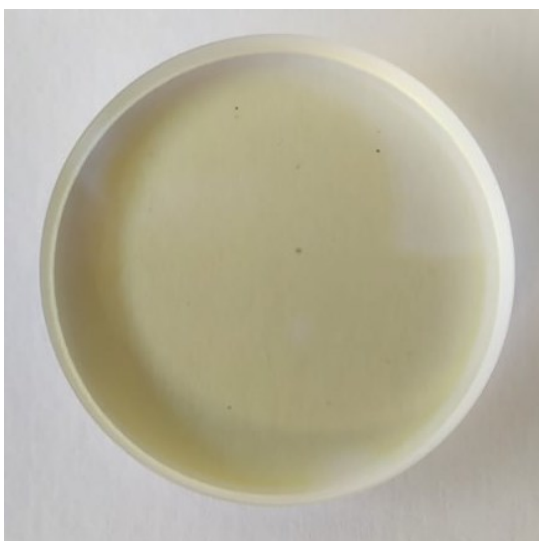
Obr. 25 Ochranné sklíčko čočky po 120 hodinách provozu
