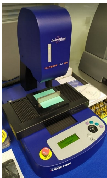
Obr. 34 Měření vzorků na přístroji Talysurf CLI 500
