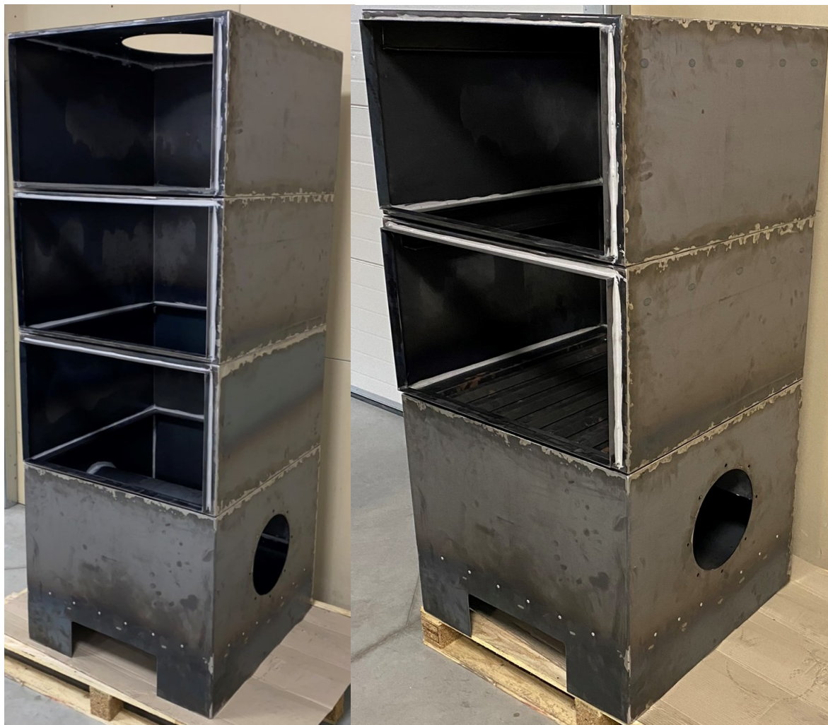
Obr. 56 Sestava zařízení s HEPA blokem (vlevo) a bez HEPA bloku (vpravo)
