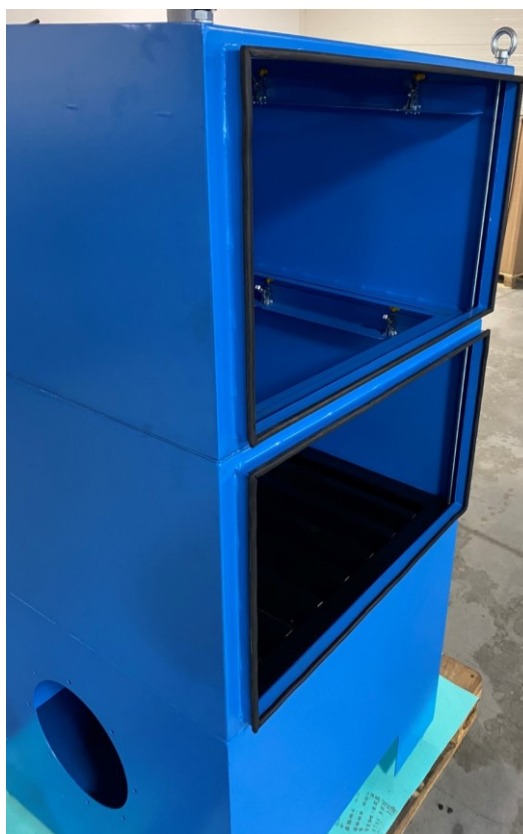
Obr. 69 Osazení těsnění dveří
