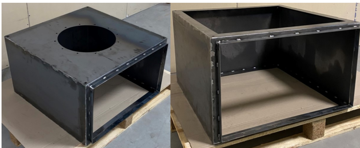
Obr. 48 Zkompletované boxy filtračního zařízení
