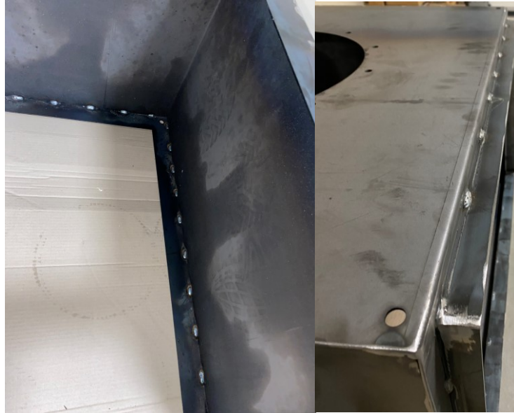
Obr. 49 Detail bodových svarů na boxech
