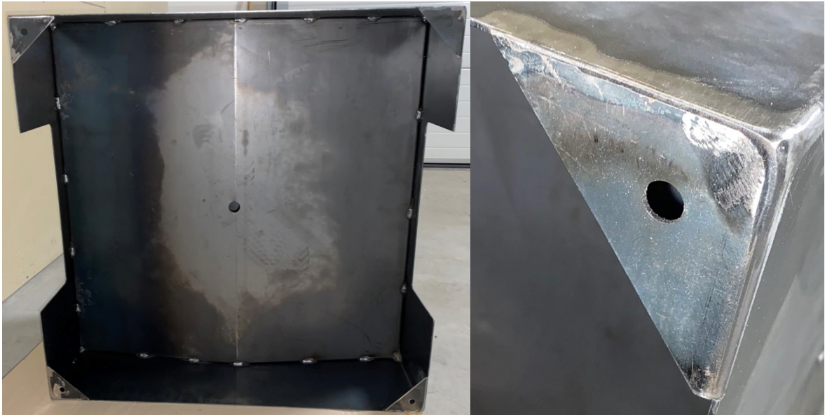
Obr. 51 Detail svarů na základním boxu
