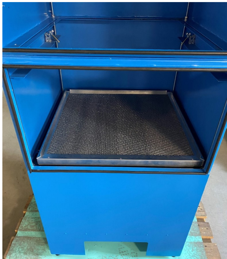
Obr. 67 Osazení tukového filtru s lamelovým filtrem
