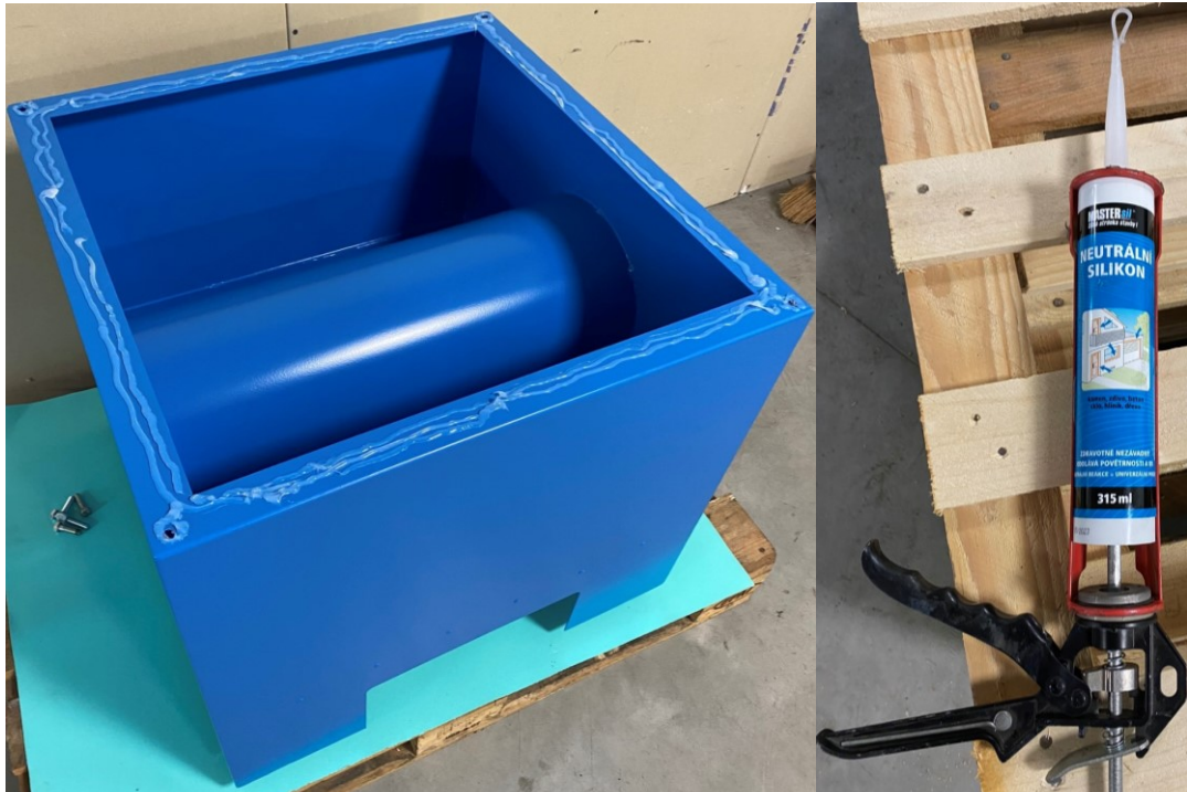
Obr. 62 Aplikace silikonového tmelu
