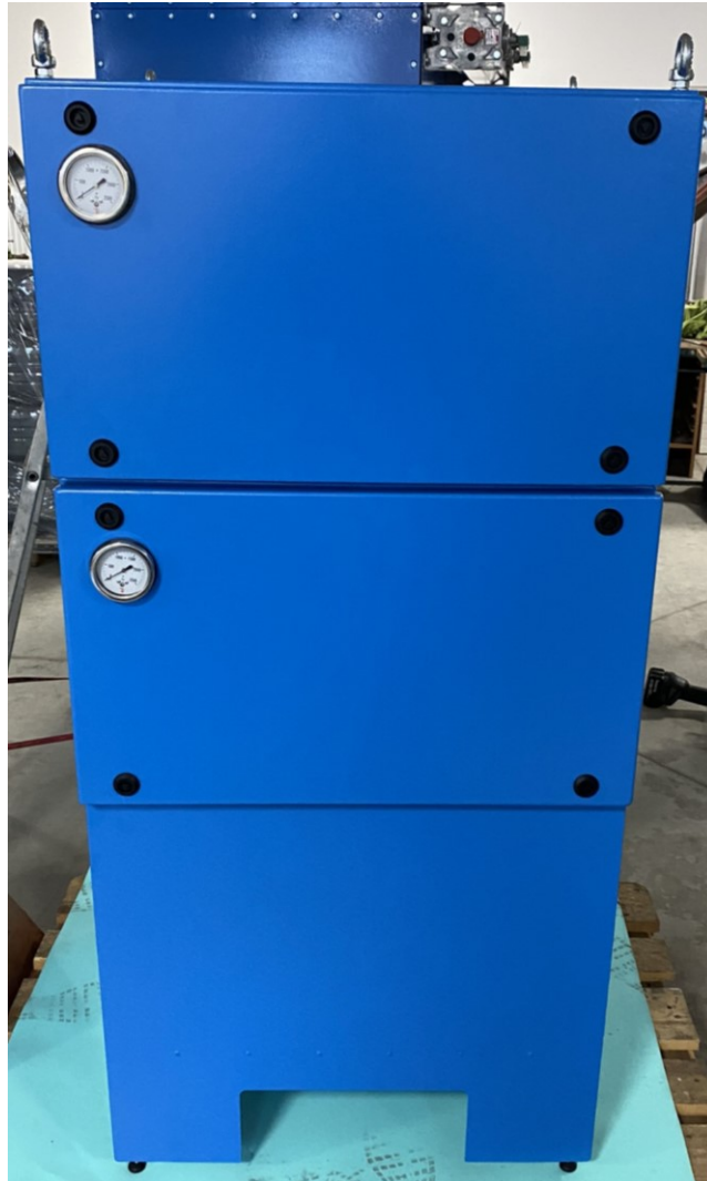
Obr. 72 Osazení dveří filtračního zařízení na jednotlivé boxy
