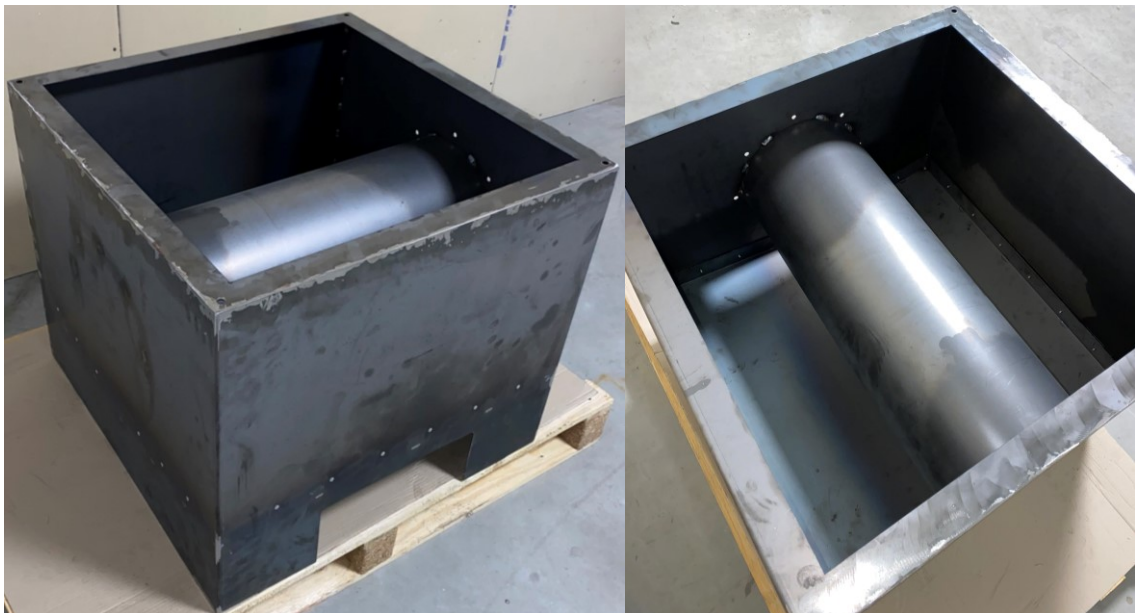
Obr. 50 Zkompletovaný základní – stavební box filtračního zařízení
