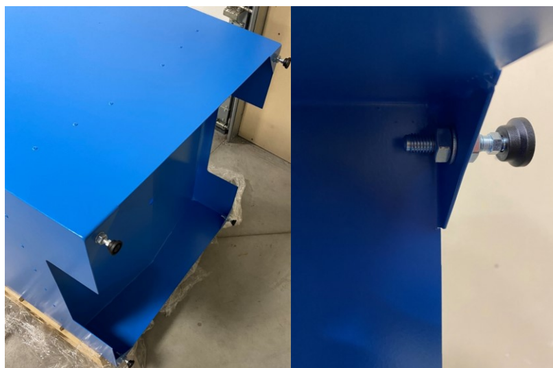
Obr. 60 Osazení stabilizačních noh
