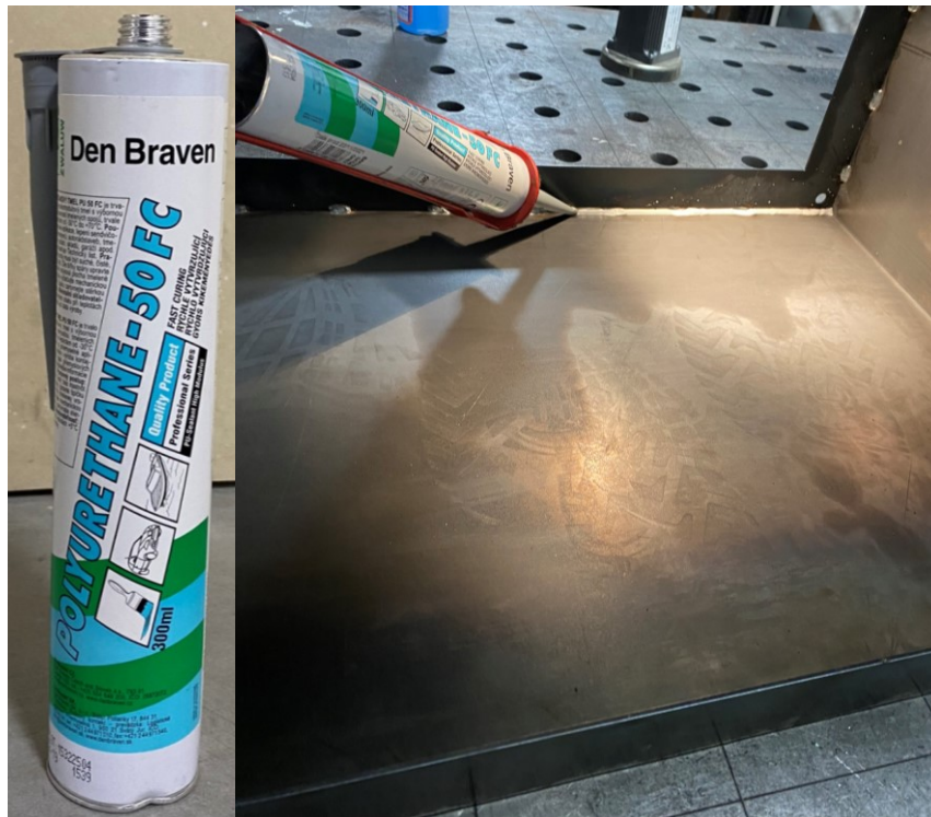
Obr. 54 Polyuretanový tmel a jeho aplikace
