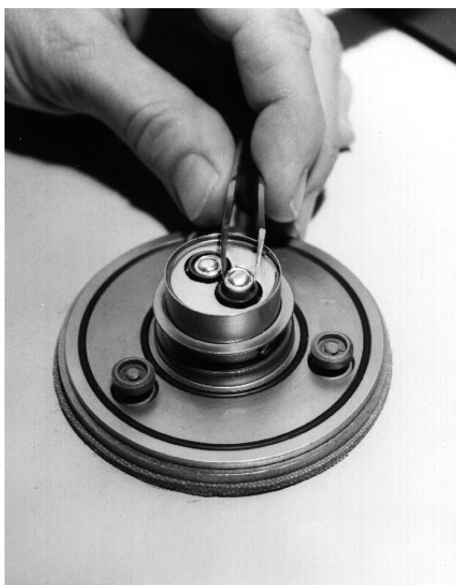
Obr. 13 Vzorek umístěný do zkušební pánvičky
