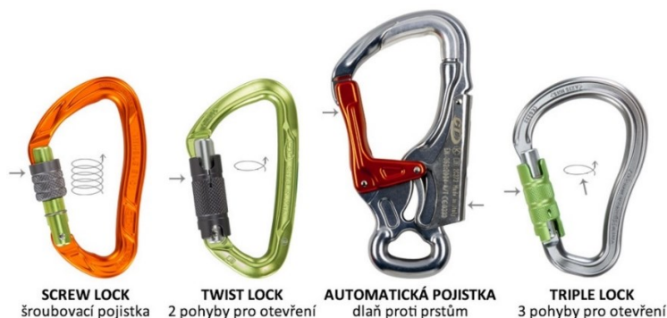
Obrázek 14 – Pojistky zámku karabin (Začínáme s lezením, © 2022)
