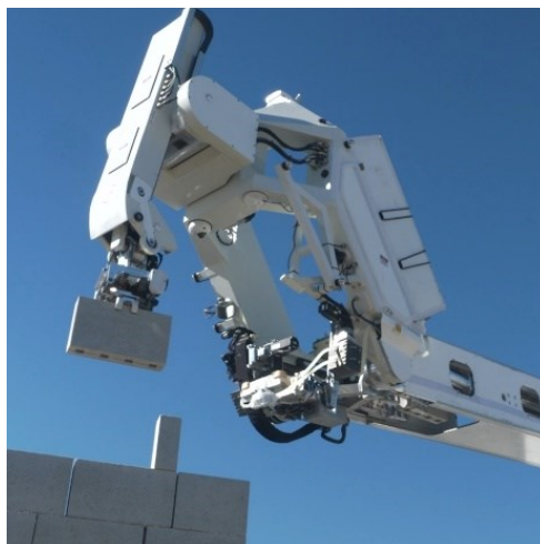
Obrázek 2. detail ramene stroje Hadrian X [8]
