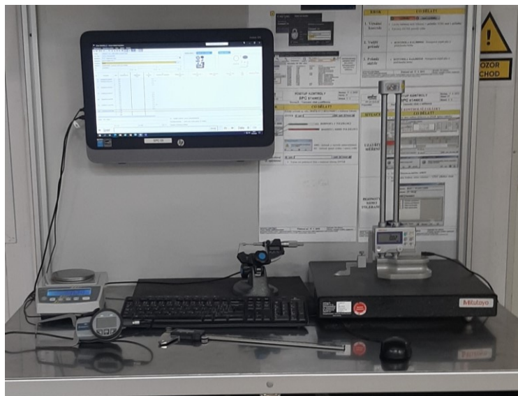
Obrázek 7: Stávající SPC stanice (Interní materiály společnosti)
