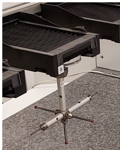
Obrázek 22 Dotyková spínací sonda HP-THDe použitá při měření
