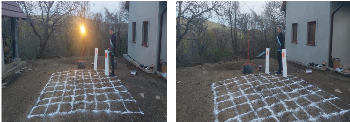
Obr. č. 43 (vľavo) Meranie po 1 m v detekčnom poli [vlastný]
