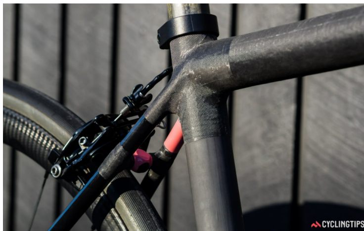
Obrázek 12 – Konstrukce trubka – trubka [17]
