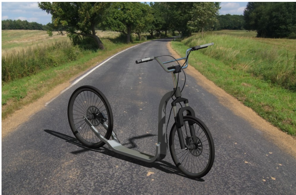
Obrázek 57 - Vizualizace navržené koloběžky pomocí renderování
