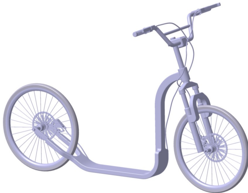
Obrázek 56 – Sestava celé koloběžky bez zvolených materiálů
