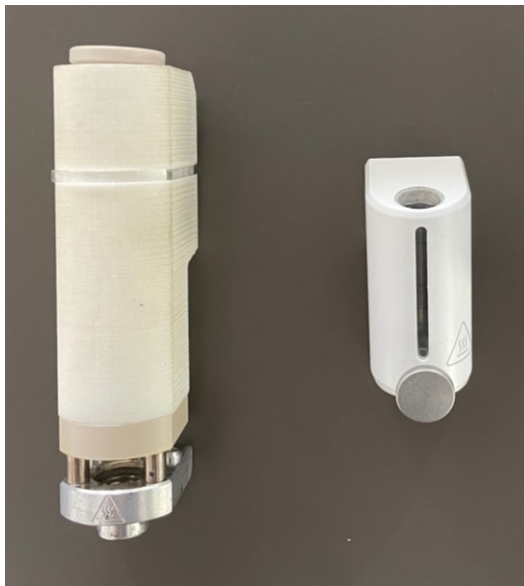
Obr. 20 – Snímky použitých tiskových hlav. Vlevo – termoplastická hlava, vpravo – pneumatická hlava.
