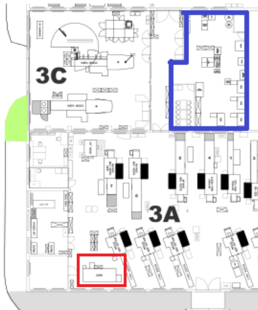
Obr. 9 Pracoviště dokončovacích operací a myčka na odmaštění výrobků
