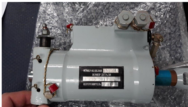
Obrázek 13: Padělaný kus servomechanizmu (Podvržené díly a falešné osvědčení, 2022)
