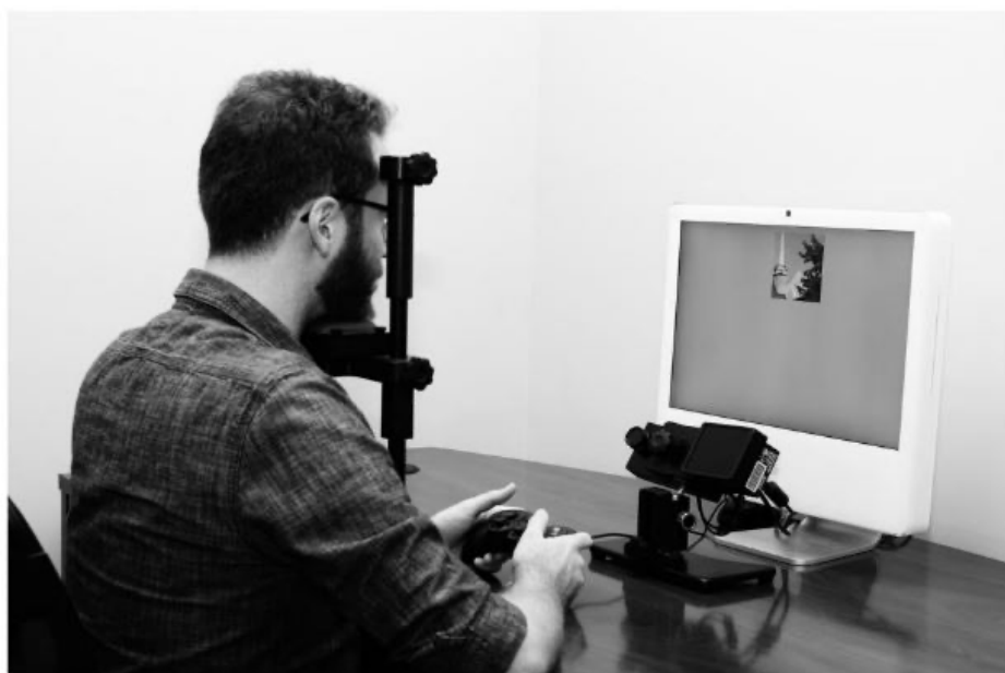
Obrázek 4 Vysoce přesné měření, hlava je stabilizovaná (Zdroj: Conklin, Pellicer-Sánchez a Gareth, 2018, s. 17)
