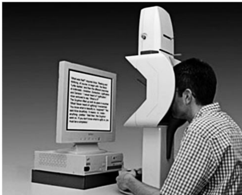
Obrázek 4 Vysoce přesné měření, hlava je stabilizovaná (Zdroj: Conklin, Pellicer-Sánchez a Gareth, 2018, s. 17)
