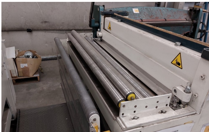
Obrázek 27 NC dělicí centrum – rovnací válce
