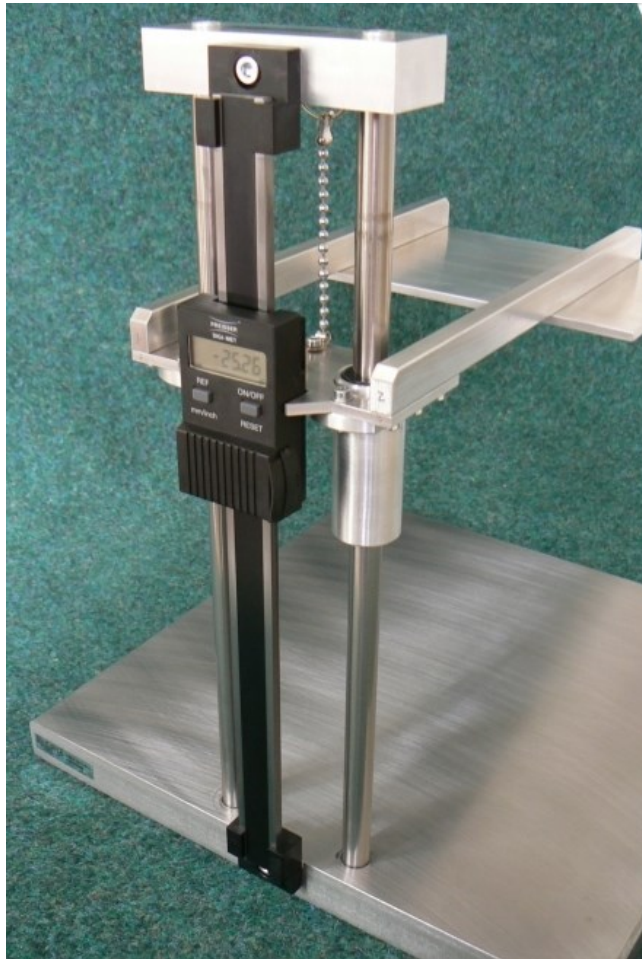
Obrázek 17 Příklad měřícího přípravku pro měření výšky [23]
