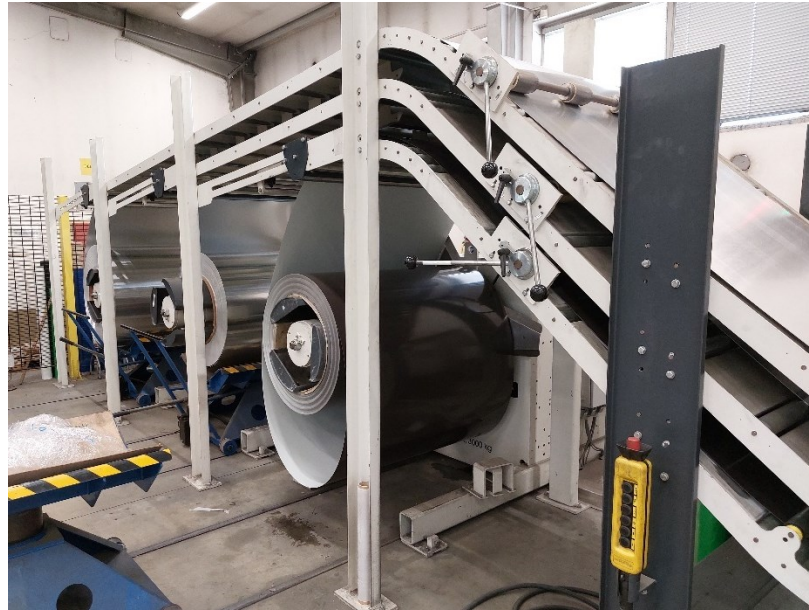
Obrázek 26 NC dělicí centrum – odvíjení svitků plechu
