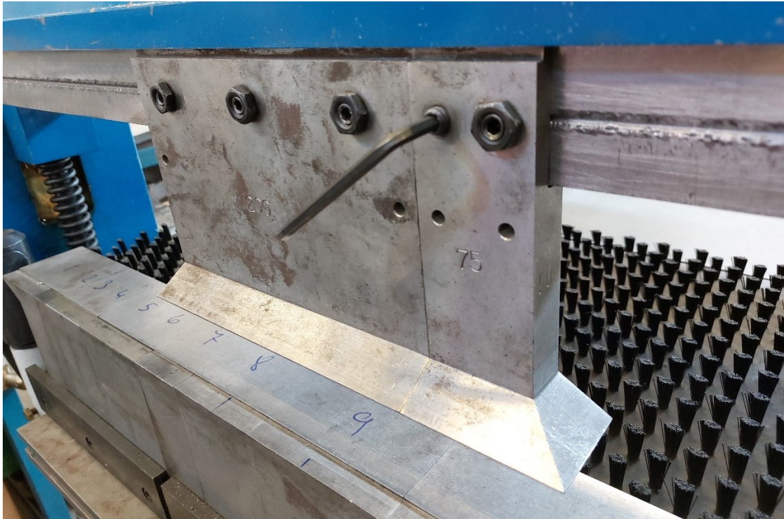
Obrázek 33 Detail upevnění přípravku k ohýbadlu
