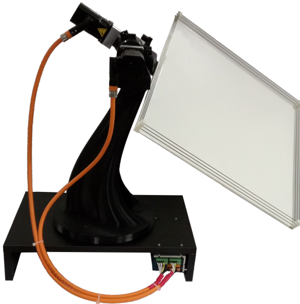
Obr. 4.15 První reálná verze modelu Kulička na nakloněné rovině
