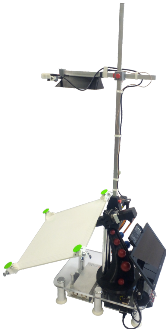
Obr. 4.17 Současná reálná verze systému Kulička na nakloněné rovině
