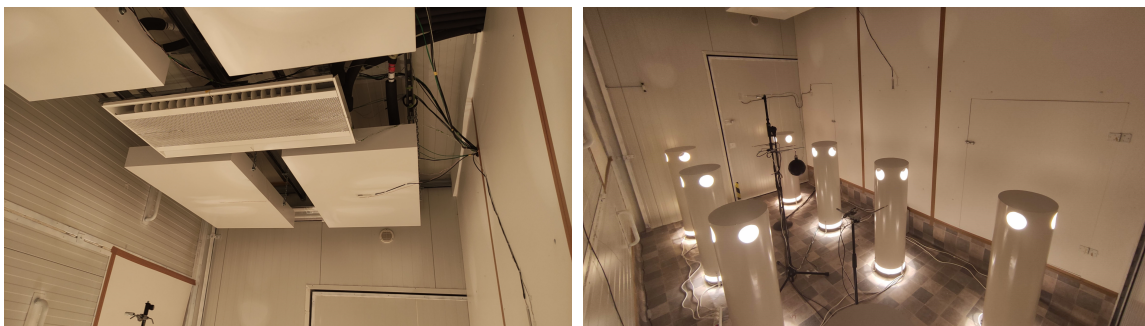
Obr. 4.4 Měření systému stropního chlazení v Indoor části KK.
