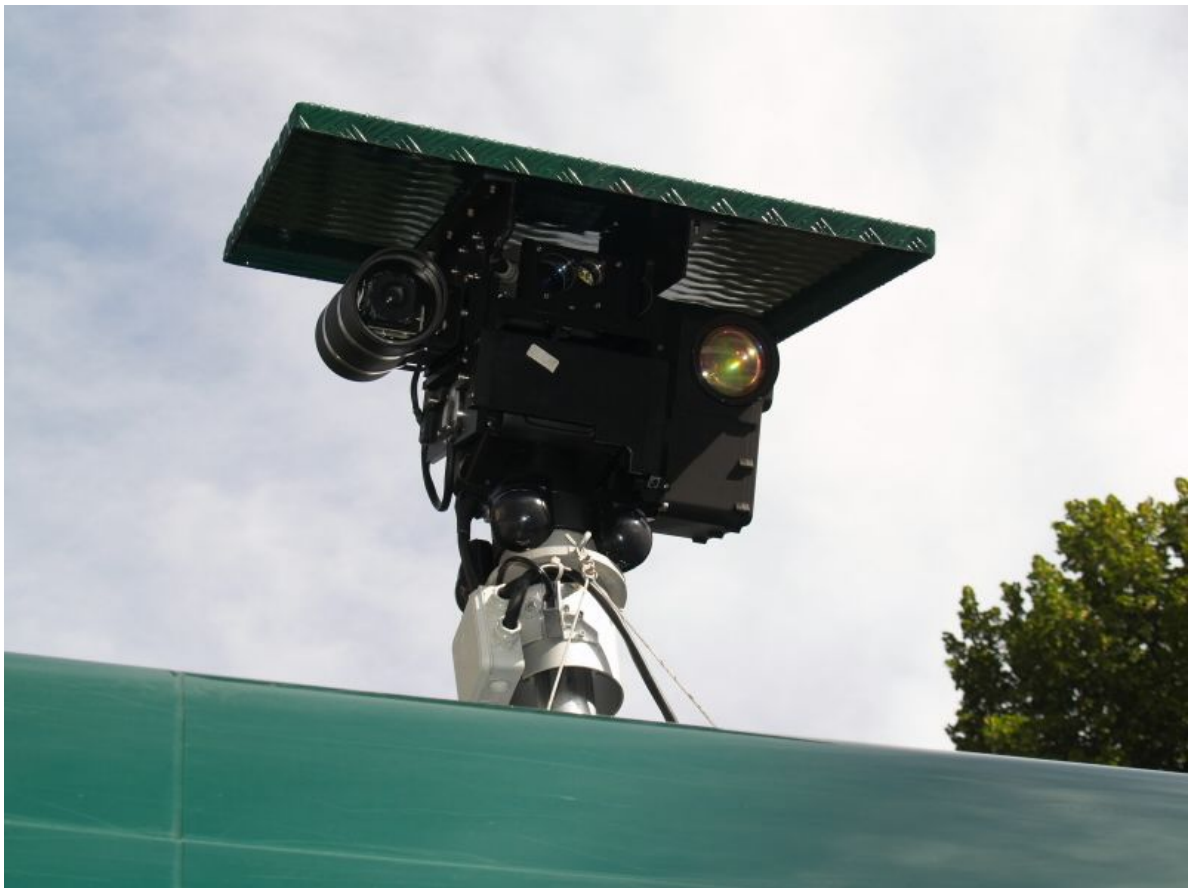
Obrázek 29: Infrakamera ve speciálním monitorovacím voze cizinecké a pohraniční policie 13
