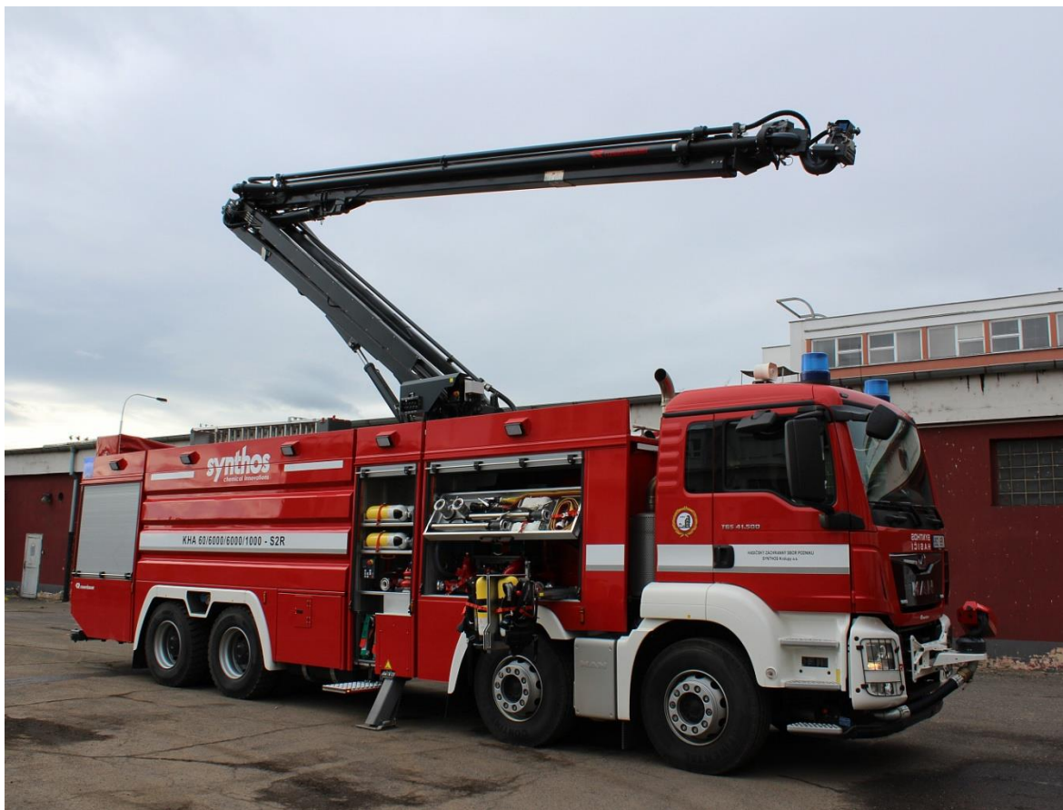
Obrázek 9 MAN TGS 41.500 KHA 60/6000/6000/1000 – S2R (Osmikolový kombinovaný hasičský automobil na podvozku MAN TGS dodal hasičům ze Synthosu Rosenbauer, 2018)
