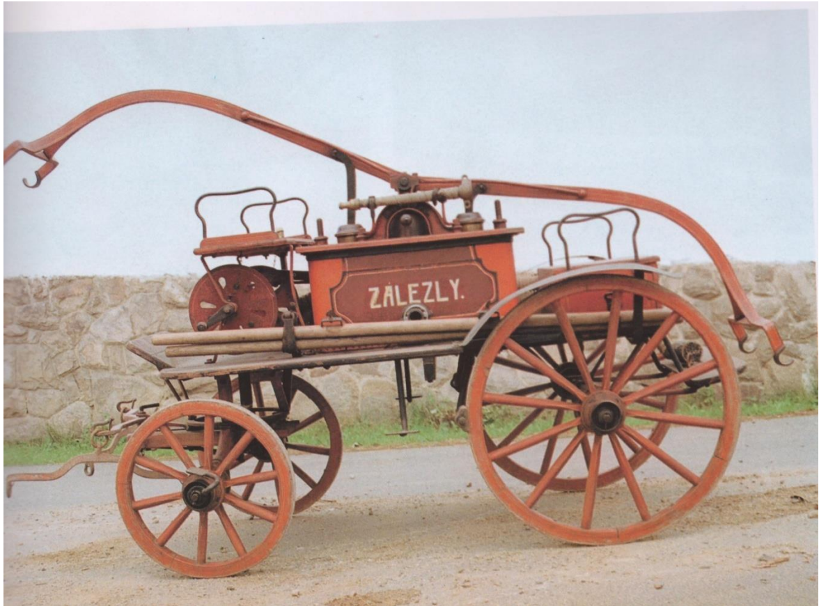
Obrázek 2 Ruční záprahová čtyřkolová stříkačka kočárového typu (Hejduk, 2001)
