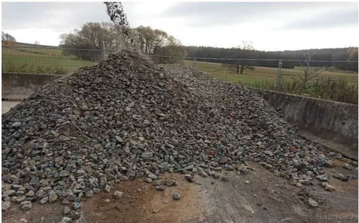
Obrázek 39 – Betonový recyklát vycházející z drtiče (vlastní).
