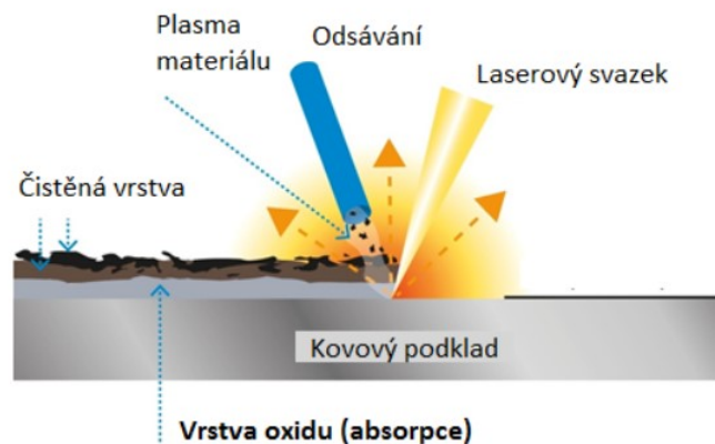
Obrázek 8. Princip laserového čištění [17].
