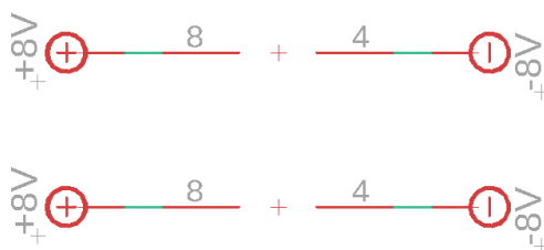
Obrázek 23 Připojení napájení k pinům operačních zesilovačů
