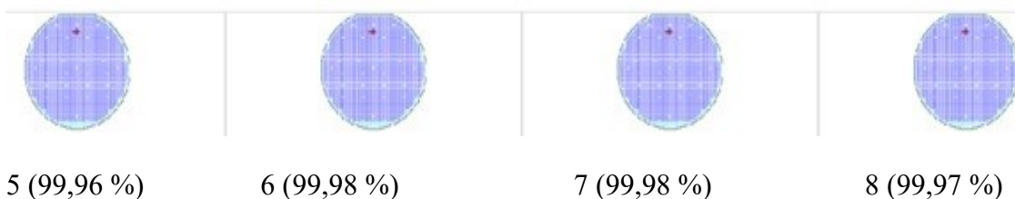
Obrázek 81 Ukázka map změřených desek 5 – 8 s procen. výtěžností přes 99% pro impl. dávku 3.08 E+15 (Vlastní zpracování)
