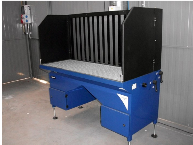
Obrázek 31 – moderní svářecí stůl se zabudovaným filtrem
