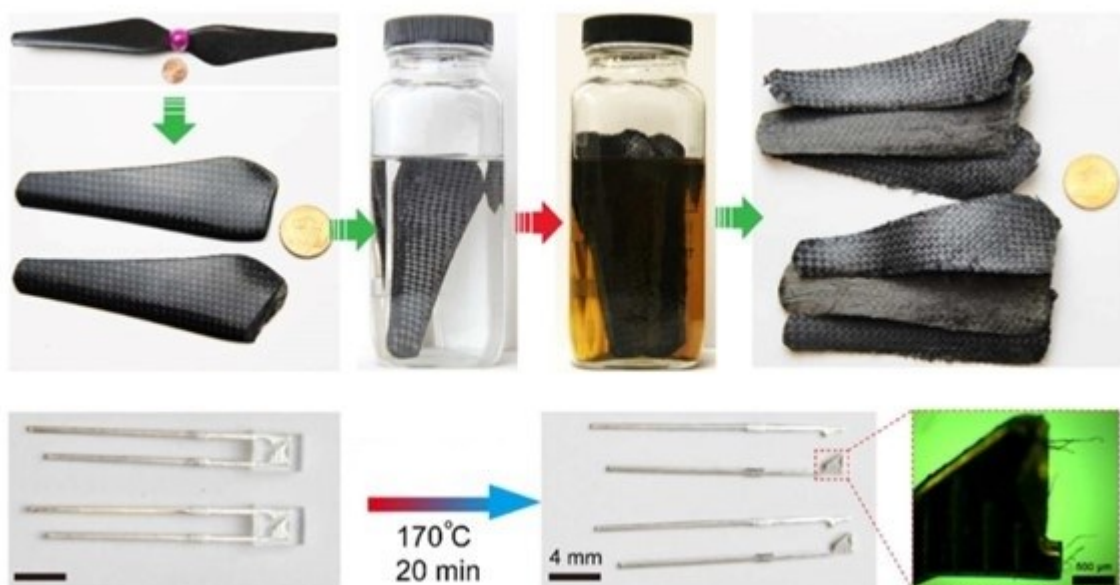
Obrázek 24 Aplikace chemické recyklace na kompozity: regenerace tkaniny z uhlíkových vláken z vrtule po namočení v recyklačním roztoku po dobu 2 hodin při 170 °C (nahore) a regenerace kovové katody z LED zapouzdřené epoxidem (dole) [42]
