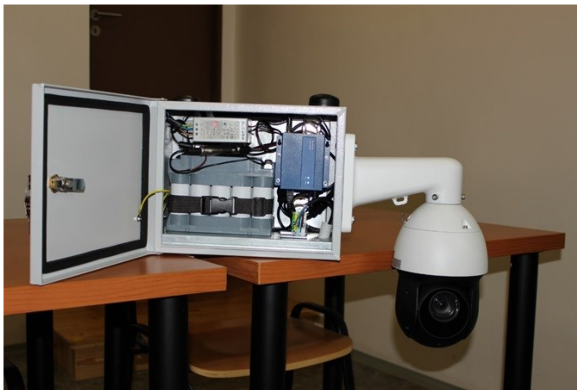
Obrázek 33 Fotografie elektroniky mobilní kamery (Městská policie Prostějov, 2022)
