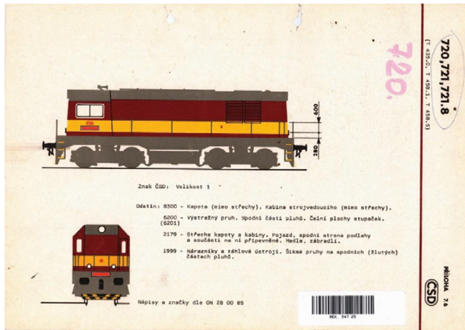
Obr. 6. Vizualizácia žltého bezpečnostného pásu na lokomotíve (Federální Ministerstvo Dopravy, 1988b)
