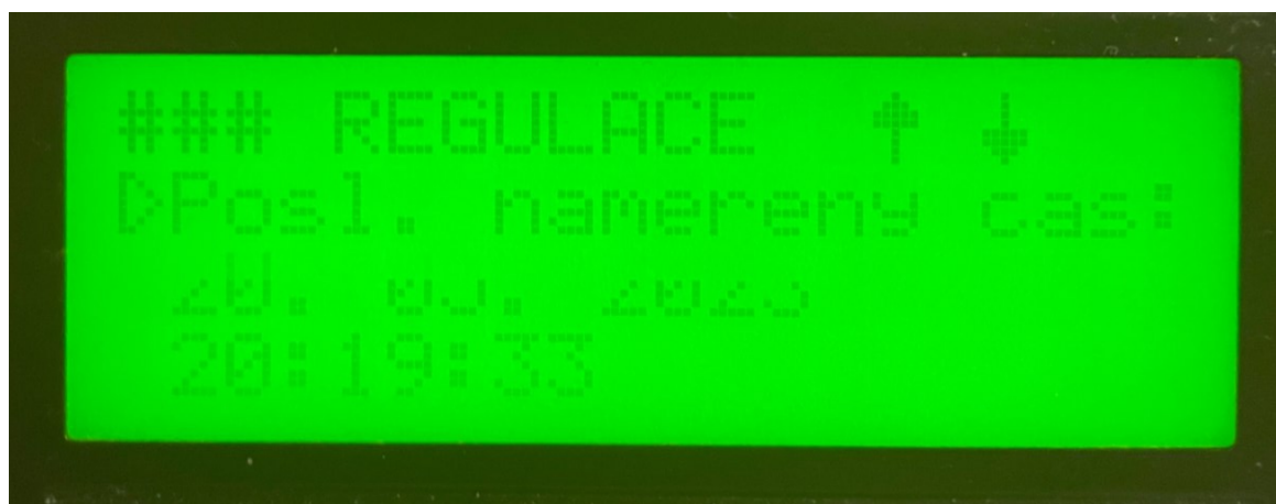
Obrázek 48 - Vzhled funkce regulace() na LCD displeji
