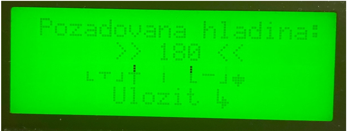
Obrázek 50 - Vzhled nastavování parametru na LCD displeji
