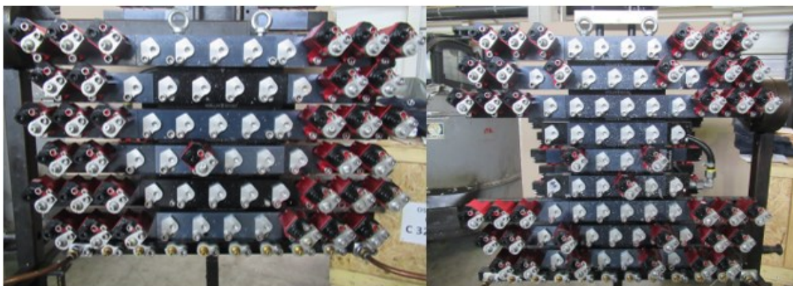
Obrázek 66: Nastavení a uspořádání mikro postřikové hlavy na pevnou a pohyblivou polovinu formy
