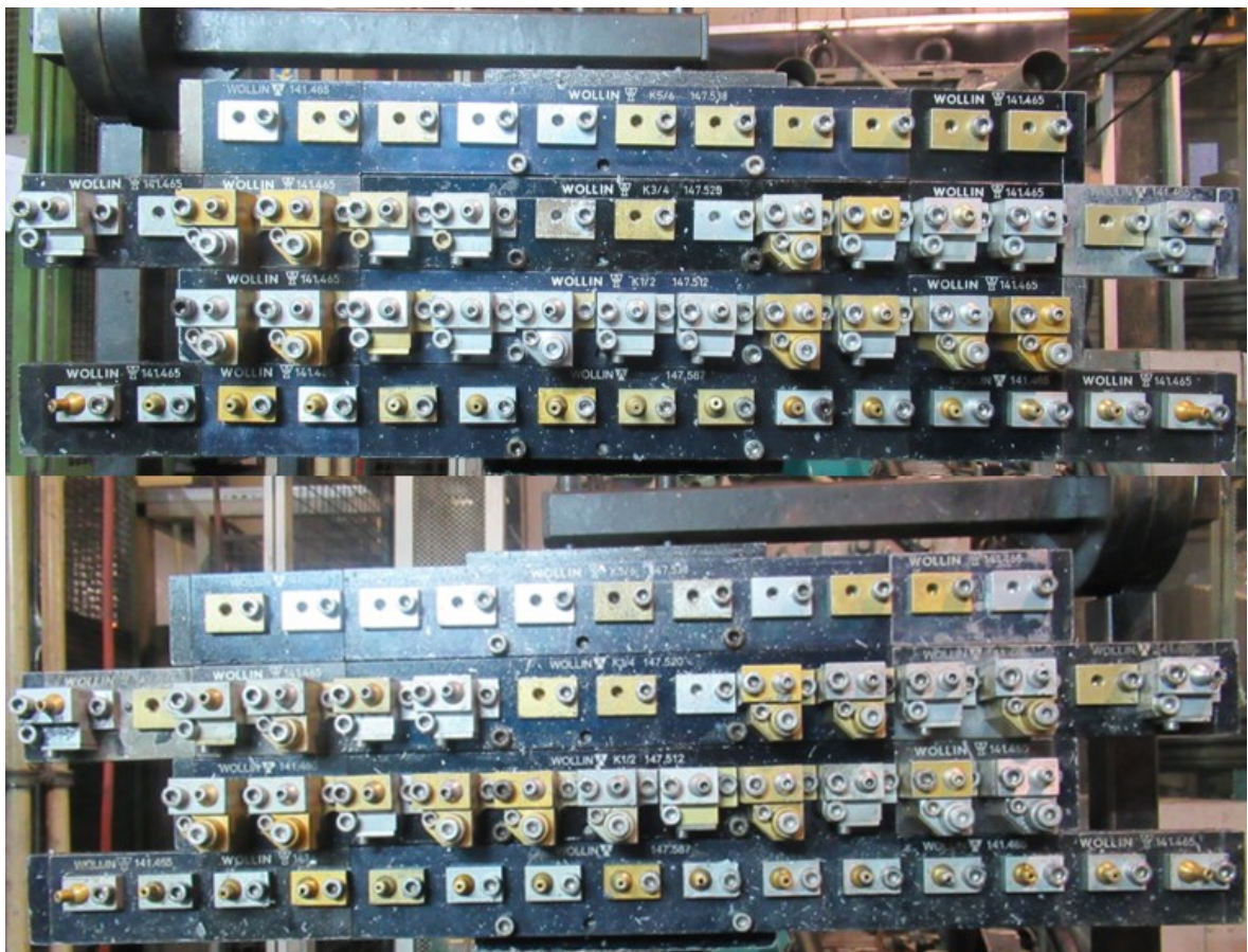
Obrázek 68: Nastavení a uspořádání konvenční postřikové hlavy na pevnou a pohyblivou polovinu formy
