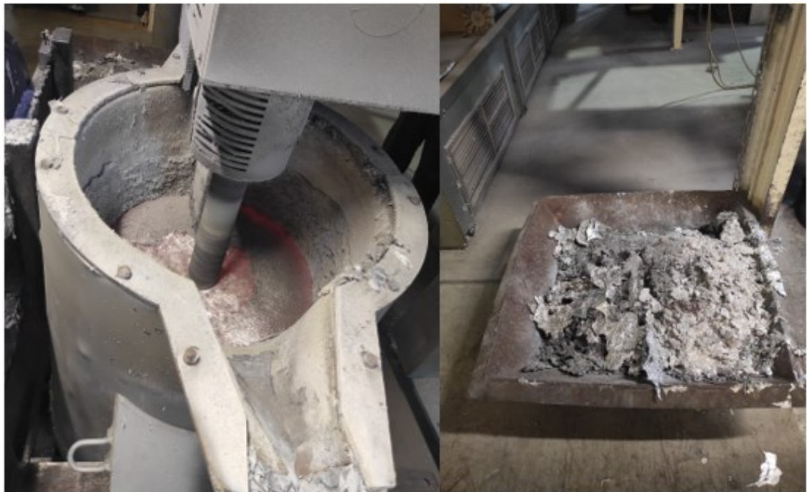
Obrázek 26: Odplynění a čištění taveniny, přístroj FOSECO FDU Mark 100 MTS 1500
