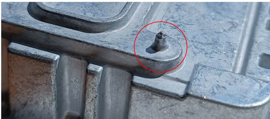
Obrázek 74: Zalomený pin odlitku
