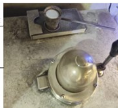
Obrázek 27: Měření indexu hustoty taveniny
