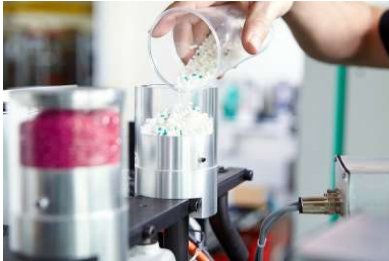
Obr. 13 Granulát přiváděný do Freeformeru[28]
