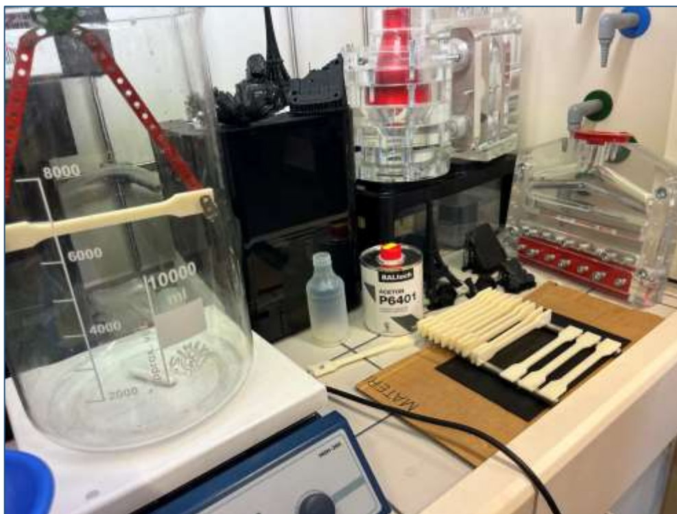
Obr. 33 Proces leptání většího testovacího dílce
