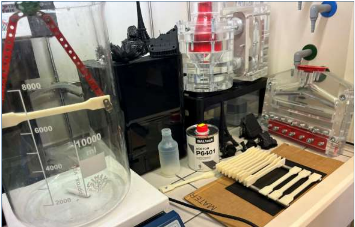
Obr. 35 Tvrdnutí materiálu po vyjmutí z mlhy
