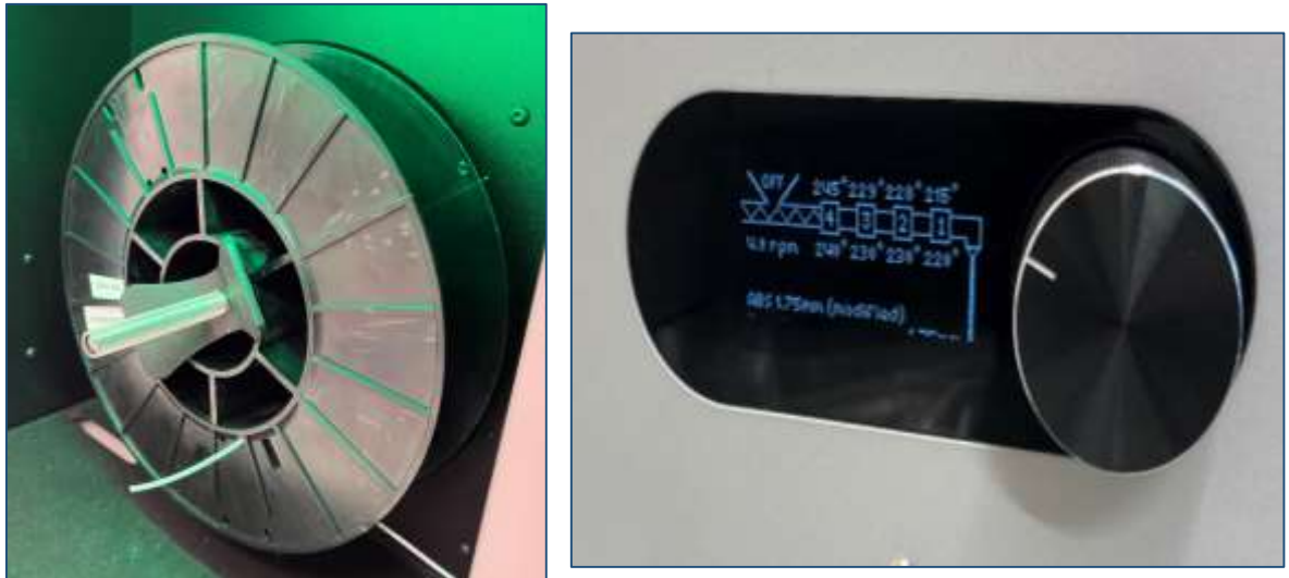
Obr. 54 Cívka se strunou a nastavené teploty pásem
