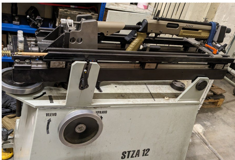
Obrázek 42: Brokovnice Fabarm STF-12, uchycená v mobilním střeleckém zařízení STZA 12
