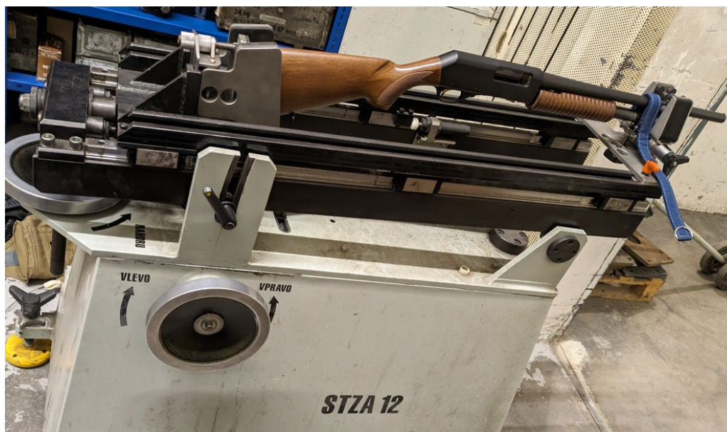
Obrázek 41: Brokovnice Fabarm Brescia pump, uchycená v mobilním střeleckém zařízení STZA 12
