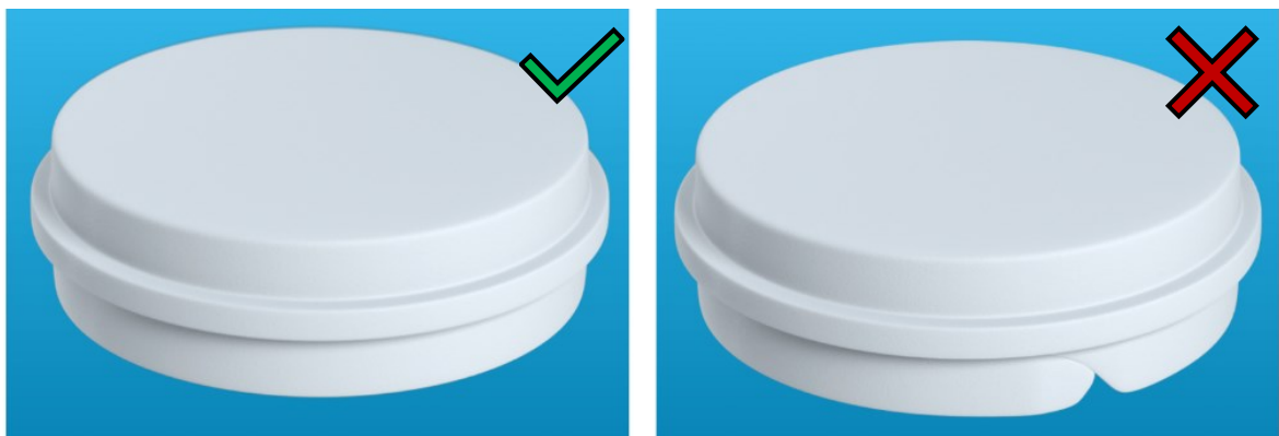
Obr. 10 Nedotečený výrobek (vpravo) [21]
