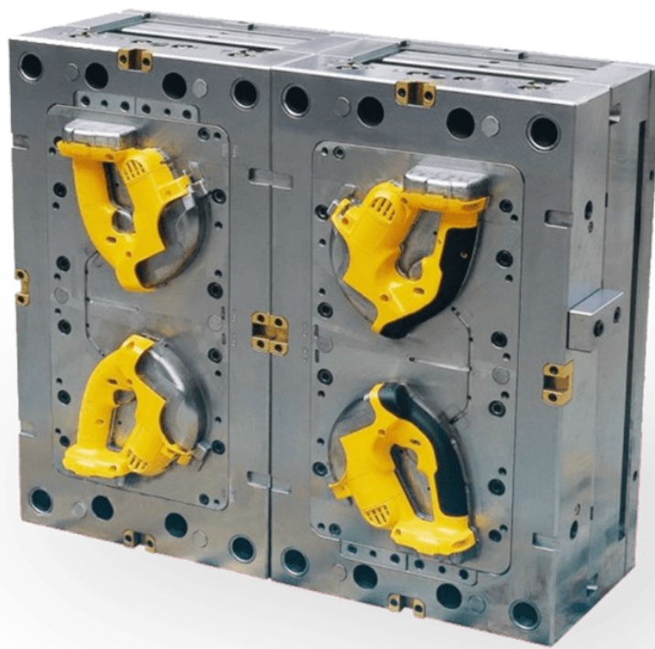
Obr. 19 Forma pro dvou komponentní vstřikování. V první fázi dojde ke vstřiknutí žluté části dílu. Poté dojde k rotaci formy o 180° podél osy vstřikování a následně je vstřiknut černý termoplastický elastomer sloužící pro lepší úchop. [32]
