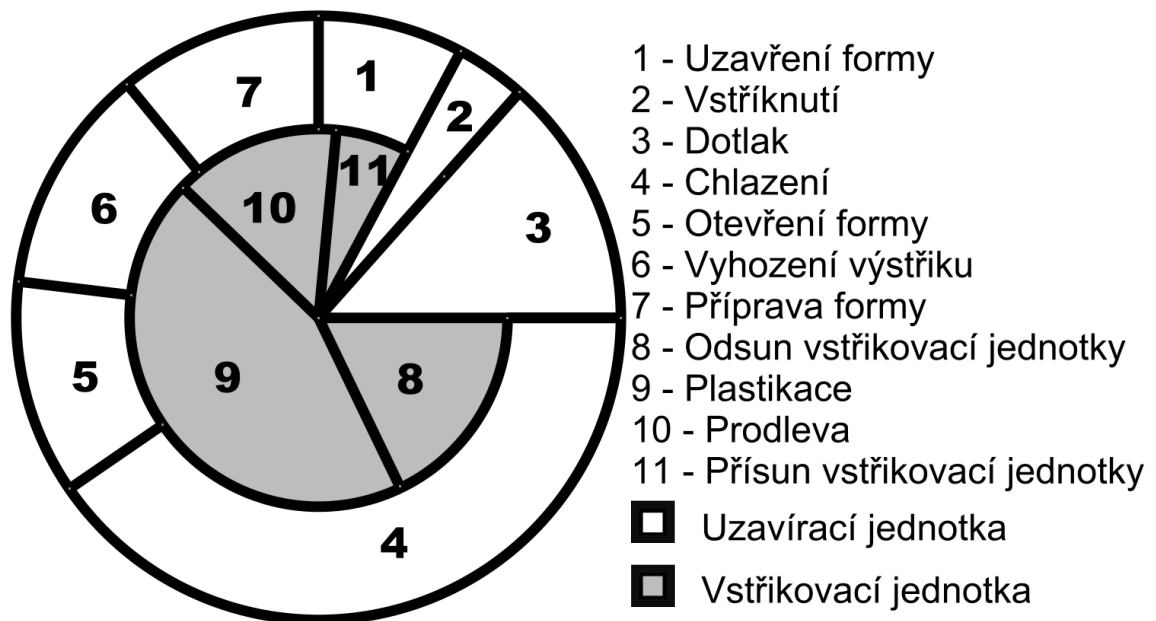
Obr. 3 Schéma vstříkovacího procesu
