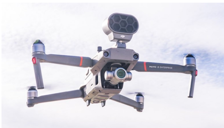
Obrázek 38 Dji Mavic 2 EA s akustickým modulem (Youtube.com, 2019)
