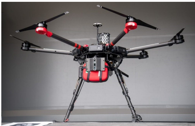
Obrázek 35 Švédský RPAS upraven k transportu AED (Zachranasluzba.cz, ©2022)
