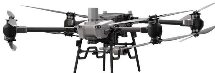
Obrázek 41 Dji Flycart 30 v navijákovém provedení (Djitelink.cz, 2024)
