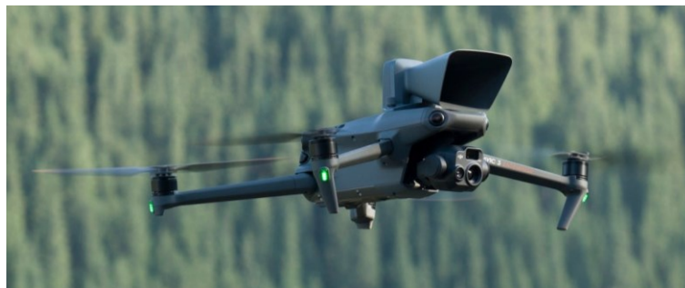
Obrázek 42 Dji Mavic 3 Enterprise s akustickým modulem (Heliguy.com, 2022)
