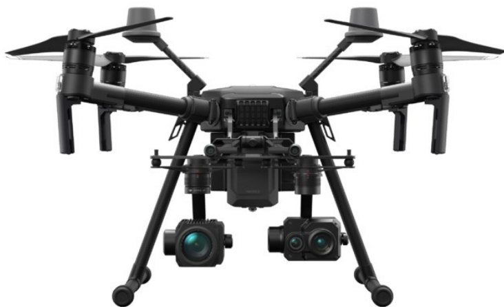
Obrázek 13 Dji Matrice 210 V2 RTK s dvojicí snímačů Zenmuse (Dronpro.cz, 2023)
