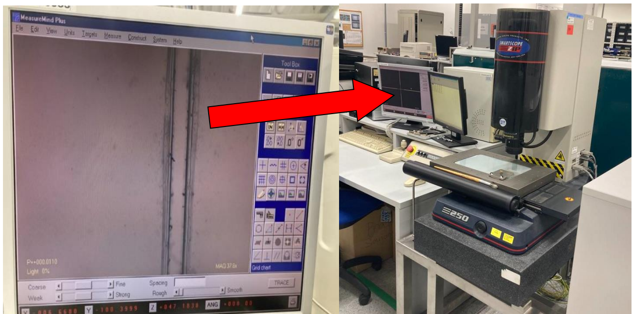
Obrázek 30 Měření pomocí zařízení profil projektor
