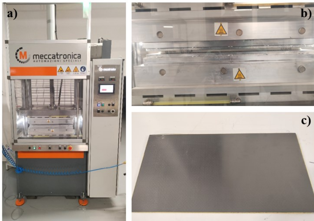
Obrázek 40 a) Elektrický lis E-FORM XI; b) Vytváření panelu lisováním; c) Vytvářený sendvičový panel po vyjmutí z lisu
