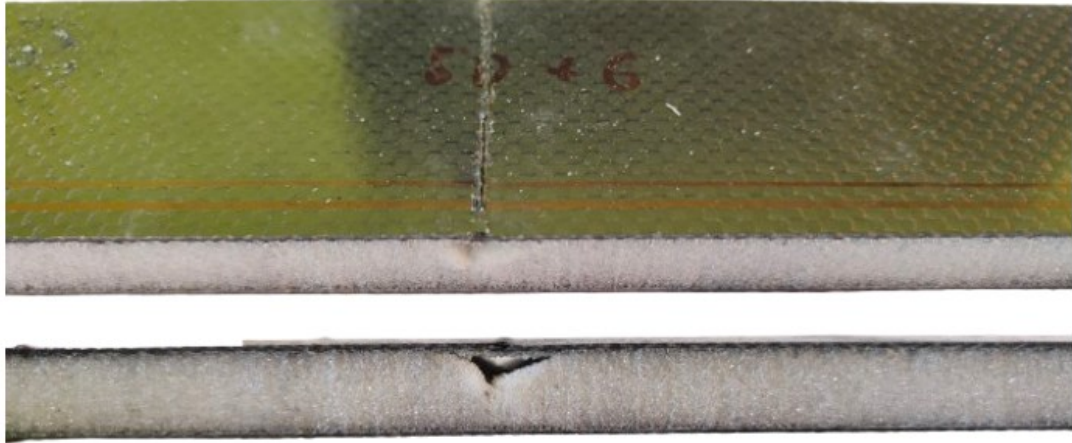
Obrázek 66 Únavový lom zkušebního tělíska RS50+G
