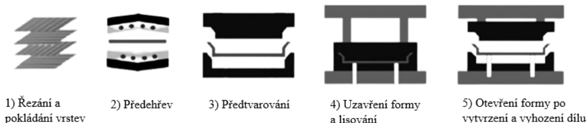
Obrázek 24 Proces lisování [1]
