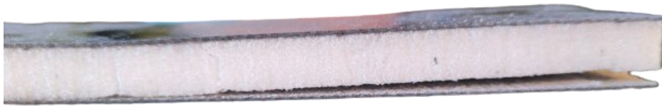
Obrázek 60 Porušení Tělíska RS30 při cyklickém ohybu
