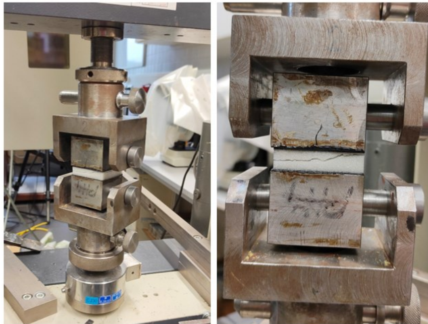
Obrázek 49 Realizace tahové zkoušky na plocho a porušení zkušebního tělesa
