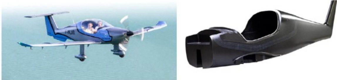
Obrázek 17 Letoun Elixir a jeho sendvičový karbonový trup [25]
