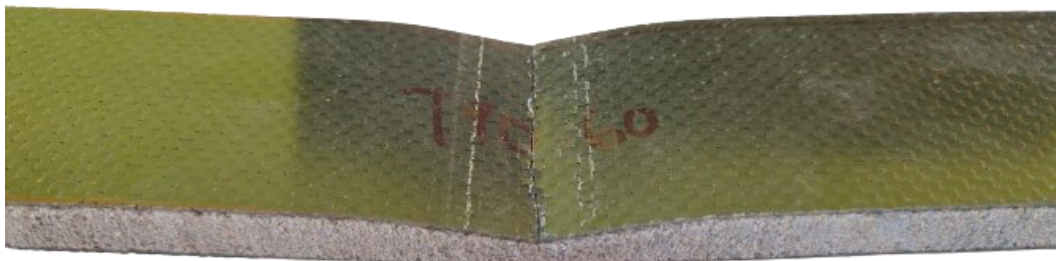
Obrázek 69 Únavový lom zkušebního tělíska T90.60
