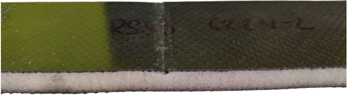
Obrázek 63 Únavový lom zkušební tělíska RS50
