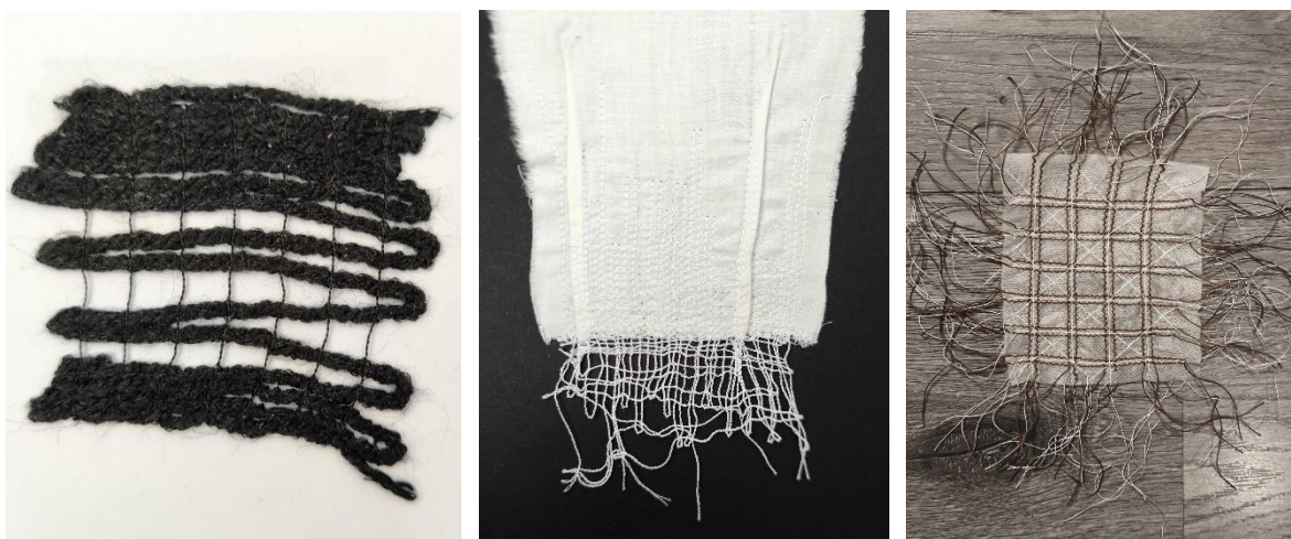
Obr. 35 Strojová výšivka na vodorozpustné textílii 128
