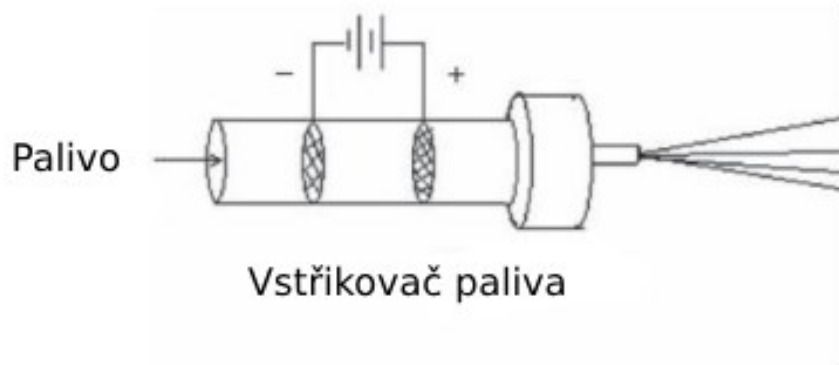
Obrázek 31 Schéma zařízení pro snížení viskozity a vstřikovače paliva [63]
