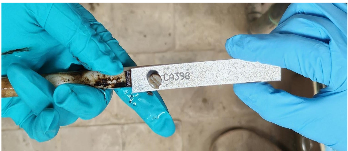
Obrázek 4 Vložení nového kuponu do korozní smyčky
