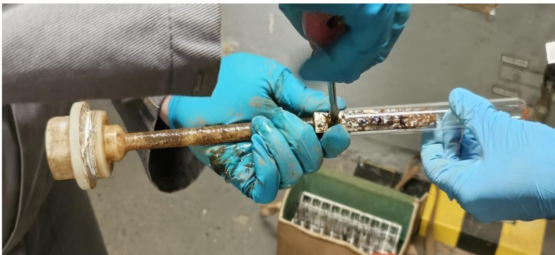
Obrázek 3 Vyjmutí exponovaného kuponu z korozní smyčky
