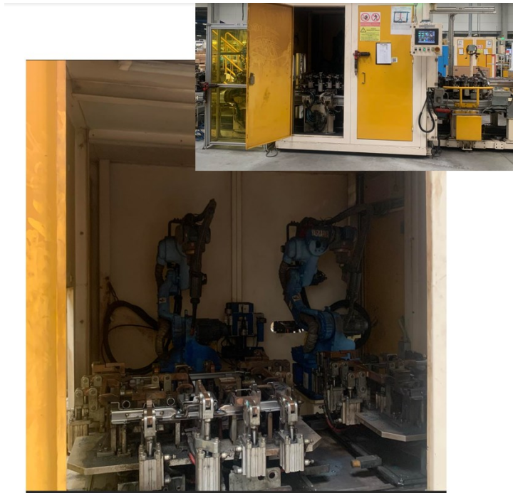
Obrázek 10 Svařovací box s roboty Yaskawa (Zdroj: vlastní zpracování)
