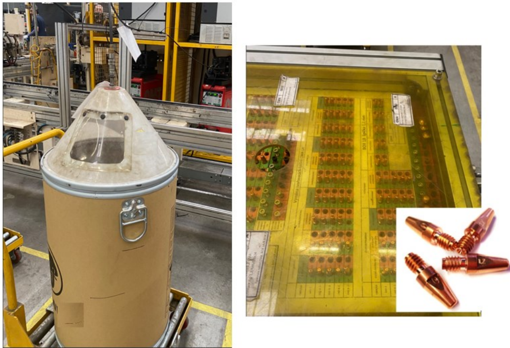
Obrázek 14 Svařovací drát v sudu, svařovací špičky (Zdroj: vlastní zpracování)
