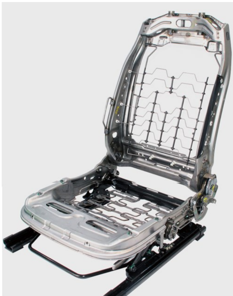
Obrázek 7 Kovová konstrukce autosedačky (Zdroj: vlastní zpracování)
