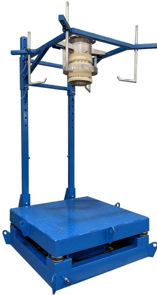
Obrázek 2: Plnicí stanice FIBC pytlů s vibrační plošinou [5]
