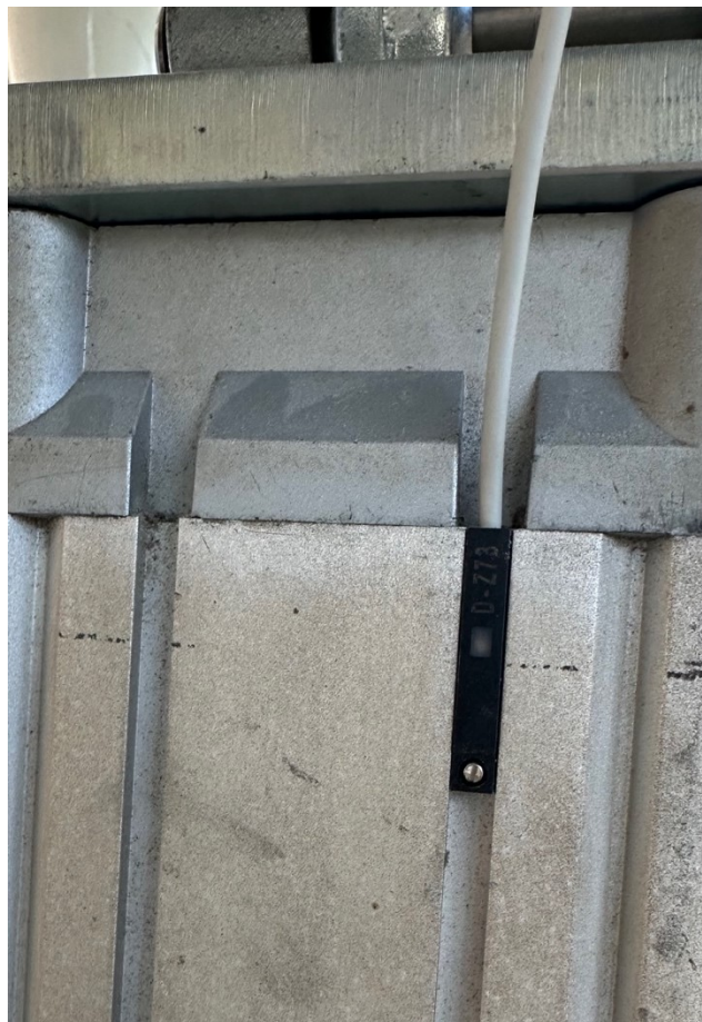
Obrázek 46: Snímač polohy pístu v drážce pneumatického válce
