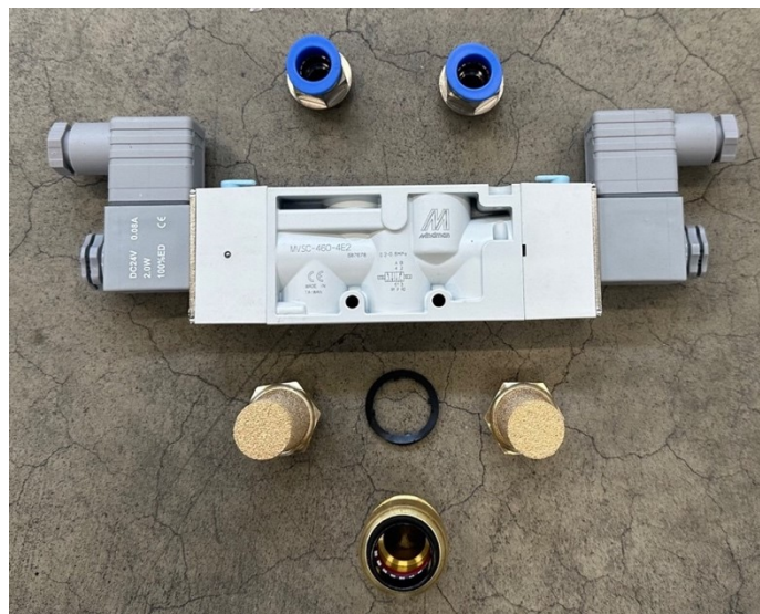
Obrázek 28: Vícecestný ventil se šroubením a tlumiči hluku
