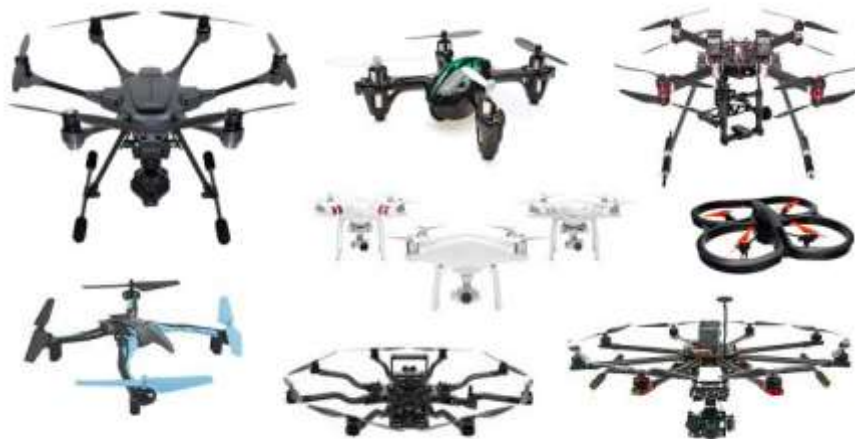
Obrázek 3 Typy multikoptér podle počtu a uspořádání motorů (3dinsider, ©2023)
