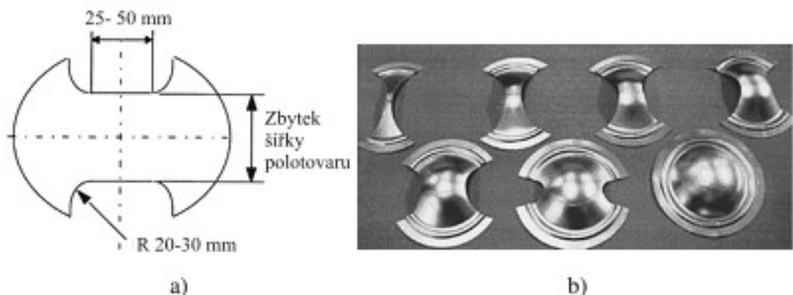
Obrázek 35. a) zkušební těleso pro stanovení FLC křivek, b) tvary zkušebních vzorků pro různé oblasti FLD diagramu [34]
