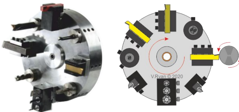
Obrázok 4 - Revolverový systém s frézovacím nástrojom
