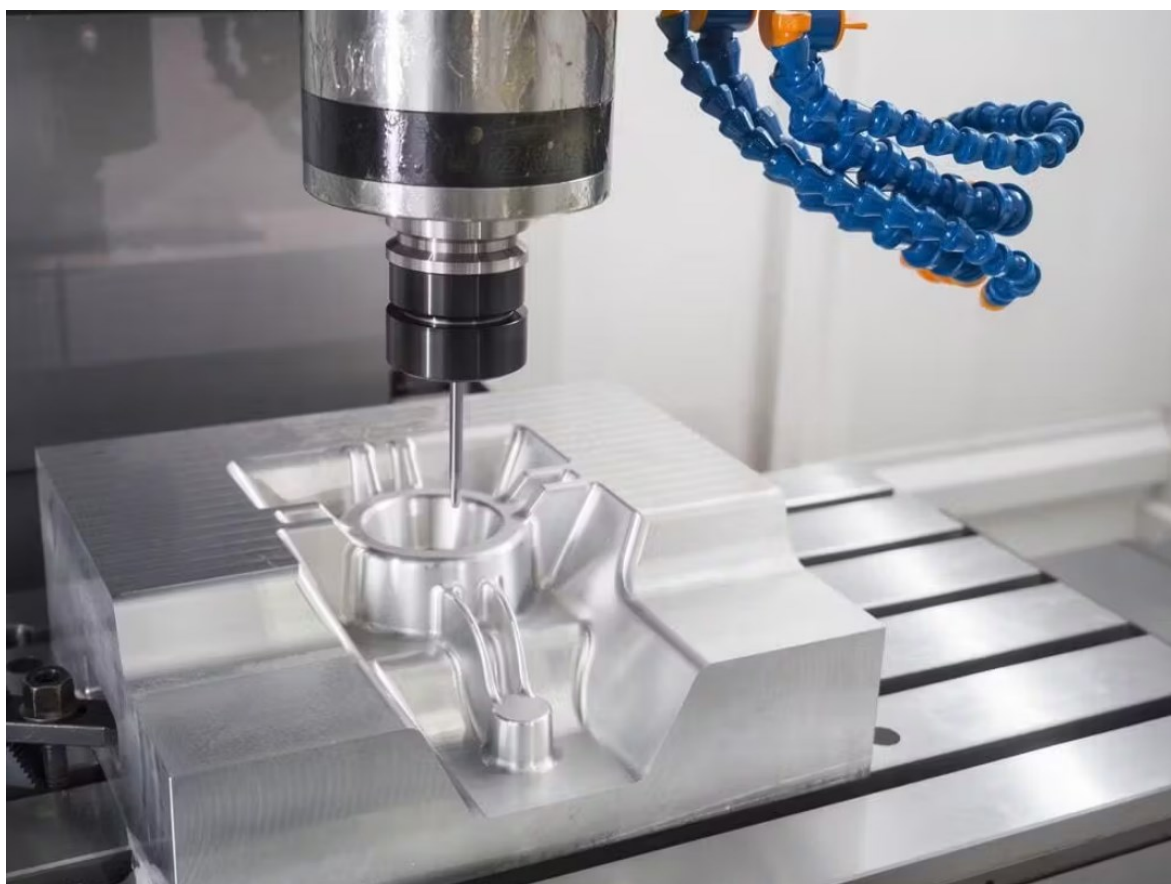
Obrázok 6 - Diel namontovaný na stole CNC frézky.
