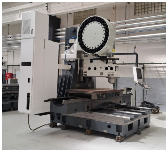
Obrázok 96 - Dokumentácia výrobného procesu, skelet so základným krytom
