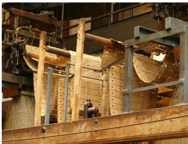
Obrázok 8 - Perforované pásy J. Jacquarda použité v tkáčskom stroji
