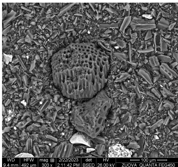
Obrázek 9. SEM snímek Biochar + DA v detailu v měřítku 100 μm
