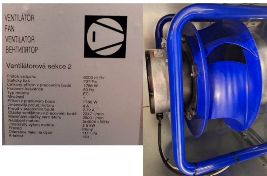
Obrázek 67 Štítek a konstrukční provedení ventilátoru ZIEHL-ABEGG[1]
