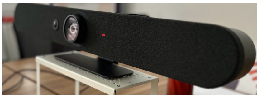
Obrázek 53 - indikace ztlumeného mikrofonu u Rally Bar Mini
