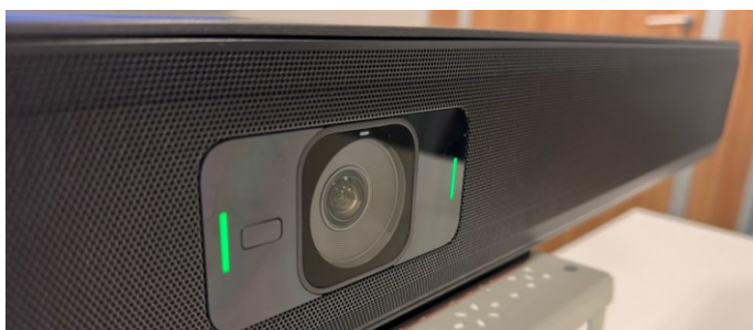
Obrázek 57 - indikace aktivního mikrofonu u Parlé VBC 2500
