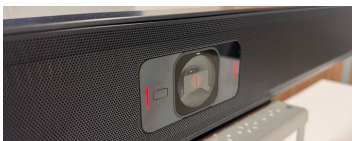
Obrázek 58 - indikace aktivního mikrofonu u Parlé VBC 2500
