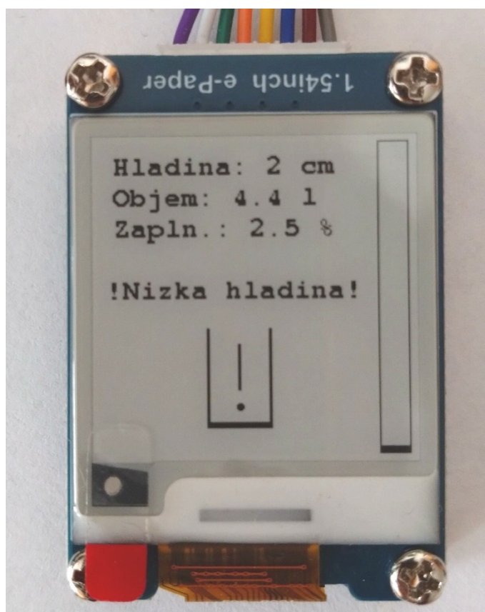
Obrázek 44 Ukázka E-INK displeje zobrazujícího aktuální stav hladiny s upozorněním
