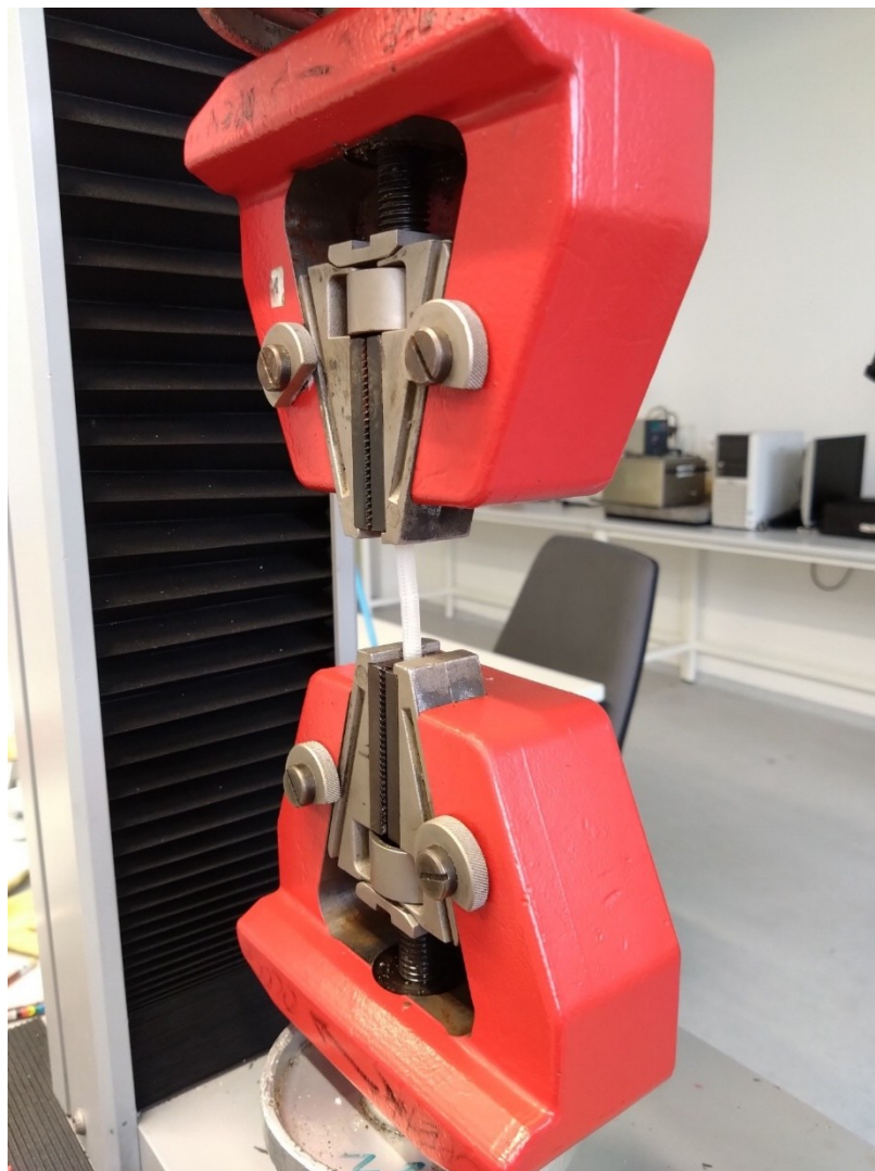
Obrázek 47 Testovací tělísko upnuté v trhačím stroji Testometric MT350-5CT
