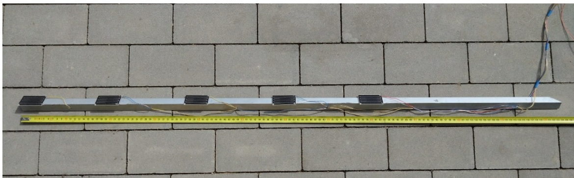
Obrázek 39 Senzor složený z 5 segmentů
