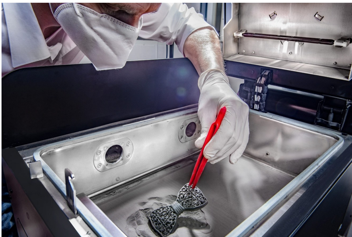
Obrázek 5 Vyjmutí výrobku vytvořeného metodou SLS [13]
