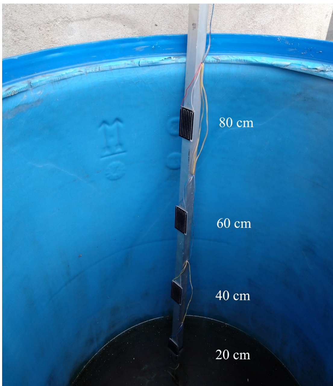
Obrázek 40 Měření hladiny vody v sudu pomocí segmentového senzoru, uvedené jsou výšky jednotlivých segmentů
