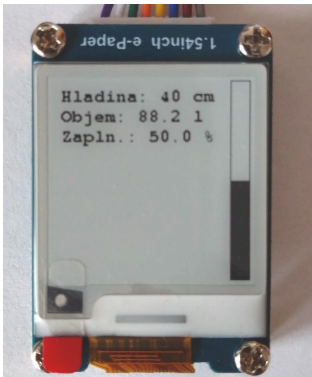
Obrázek 38 Ukázka měření hladiny – 3 senzory ponořeny, výška hladiny je 40 cm, zobrazení na E-INK displeji
