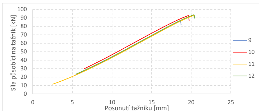
Obrázek 55 – Závislost F_{\text{Break}} na H_{\text{Break}} pro ocel HCT980X pro zkoušku dle Nakajimi bez brzdné drážky (7 kN)
