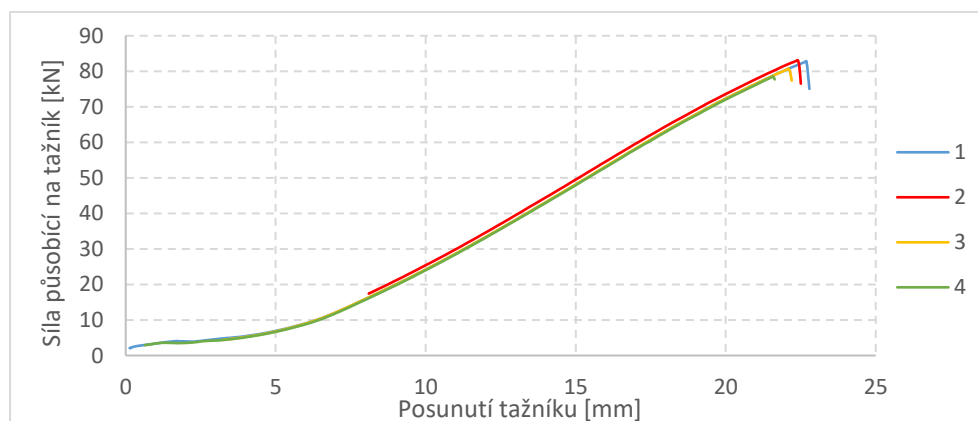
Obrázek 76 – Závislost F_{\text{Break}} na H_{\text{Break}} pro ocel HCT980X pro zkoušku dle Nakajimi s brzdou drážkou (100 kN)
