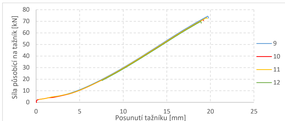
Obrázek 102 – Závislost F_{\text{Break}} na H_{\text{Break}} pro ocel HCT980XG pro zkoušku dle Nakajimi s brzdou drážkou (mazivo tažník)
