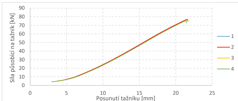
Obrázek 77 – Závislost F_{\text{Break}} na H_{\text{Break}} pro ocel HCT980XG pro zkoušku dle Nakajimi s brzdou drážkou (100 kN)
