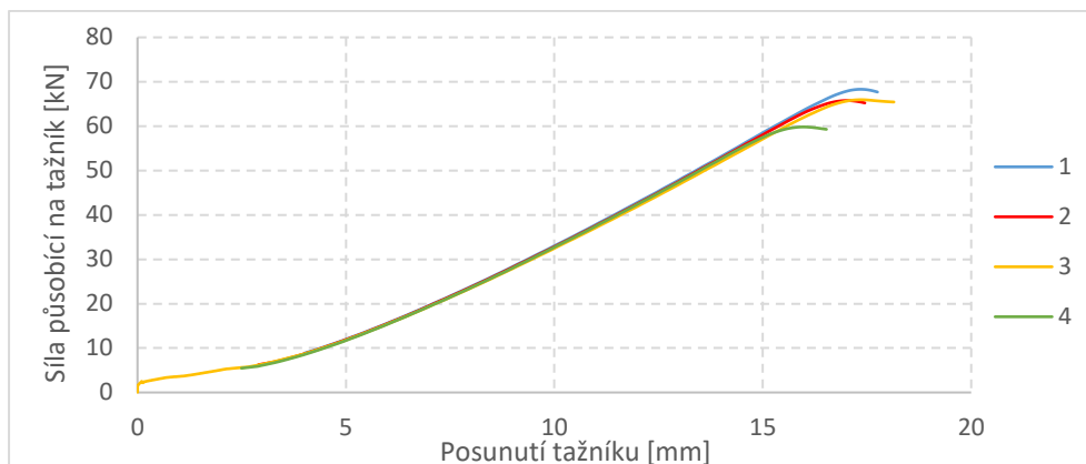
Obrázek 48 – Závislost F_{Break} na H_{Break} pro ocel HCT980X pro zkoušku dle Nakajimi bez brzděné drážky (3 kN)
