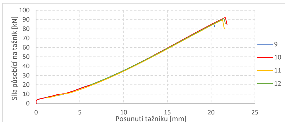
Obrázek 66 – Závislost F_{\text{Break}} na H_{\text{Break}} pro ocel HCT980XG pro zkoušku dle Nakajimi bez brzdné drážky (10 mm/s)
