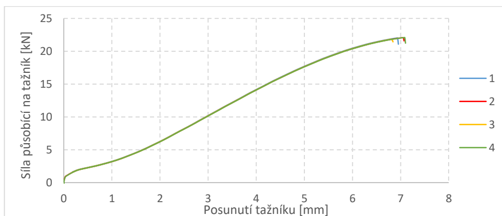
Obrázek 45 – Závislost F_{\text{Break}} na H_{\text{Break}} pro ocel HCT980XG pro zkoušku dle Erichsena
