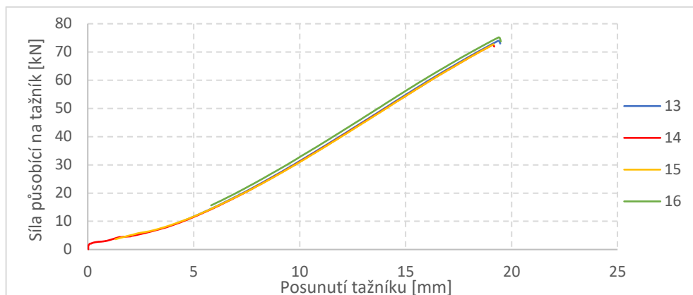
Obrázek 86 – Závislost F_{\text{Break}} na H_{\text{Break}} pro ocel HCT980XG pro zkoušku dle Nakajimi s brzdou drážkou (200 kN)
