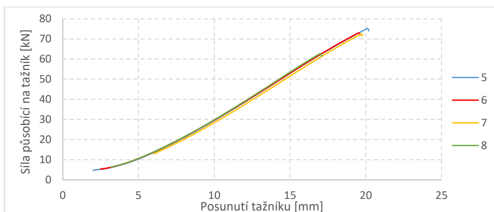
Obrázek 99 – Závislost F_{\text{Break}} na H_{\text{Break}} pro ocel HCT980XG pro zkoušku dle Nakajimi s brzdou drážkou (bez maziva)
