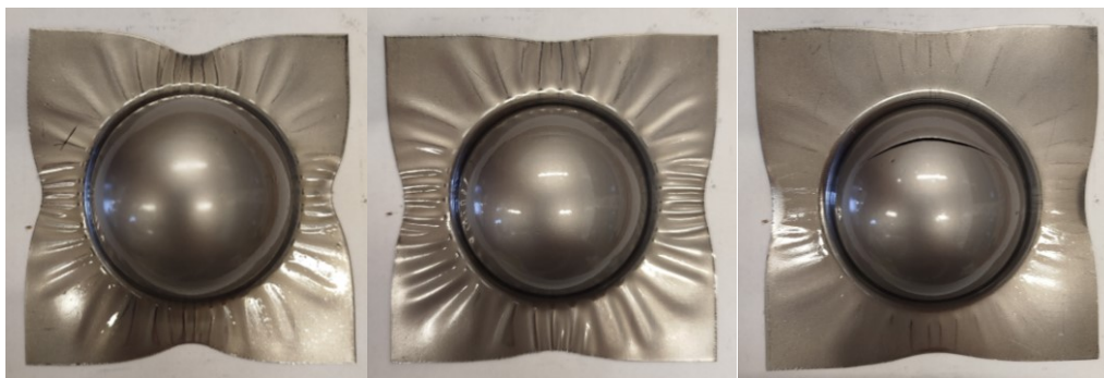
Obrázek 61 – Zvlnění materiálu při příliš nízké síle na přidržovači při testování materiálu HC420LA (1 kN nalevo, 3 kN uprostřed, 5 kN napravo)
