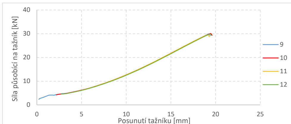
Obrázek 84 – Závislost F_{\text{Break}} na H_{\text{Break}} pro ocel HC420LA pro zkoušku dle Nakajimi s brzdou drážkou (75 kN)
