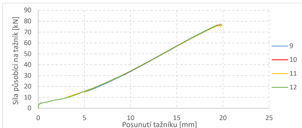
Obrázek 94 – Závislost F_{\text{Break}} na H_{\text{Break}} pro ocel HCT980XG pro zkoušku dle Nakajimi s brzdou drážkou (10 mm/s)
