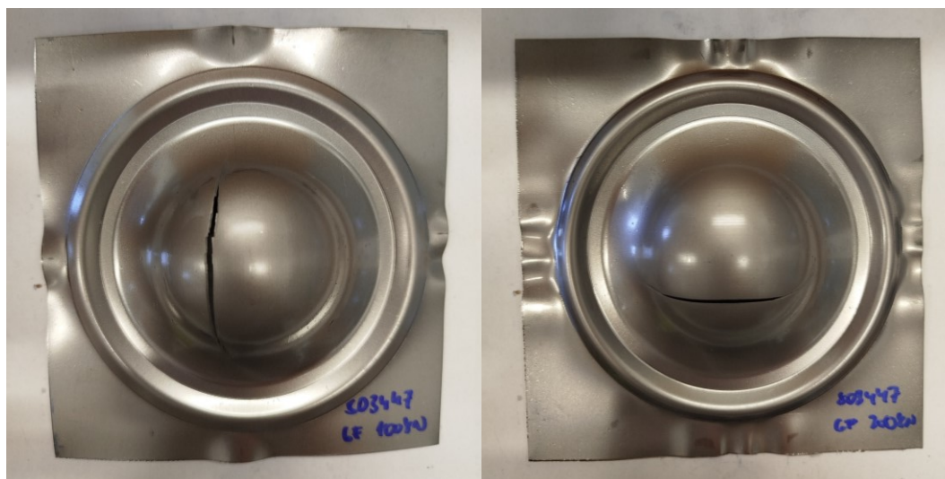
Obrázek 89 – Rozdíl vytvoření drážky s nízkou hodnotou síly na přidržovači (nalevo) a vyšší hodnotou síly (napravo)
