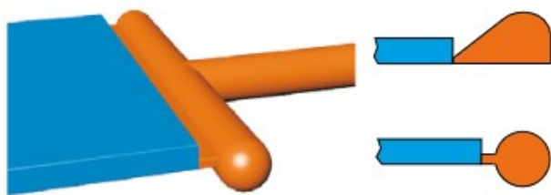
Obrázek 38 Typické konstrukce filmových vtokových ústí
