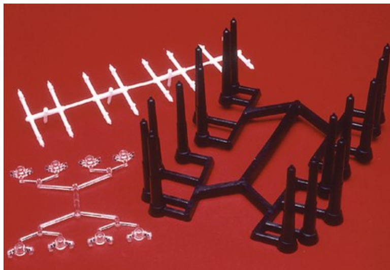
Obrázek 30 Příklady dvoudeskových vtokových systémů
